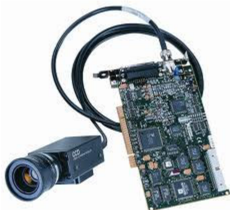
Fig. 13. Scheda elettronica per la conversione digitale di segnale analogico da videocamera e trasferimento su computer (frame grabber)
