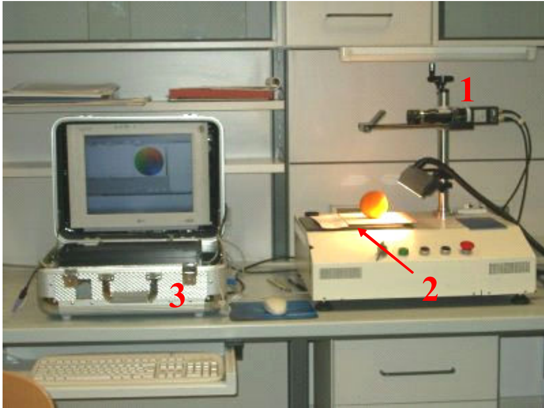
Fig 14. Sistema scanner spettrale o spectral scanner (DV srl, Padova) che associa un tavolino di traslazione orizzontale (2) al sistema ImSpector (1) consente l'acquisizione e il salvataggio su PC trasportabile (3) di immagini spettrali complete dei prodotti
