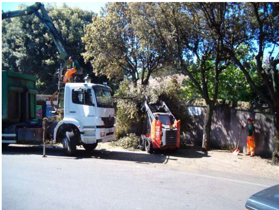
Foto 22 - Concentramento delle ramaglie di leccio con Bobcat presso autocarro
