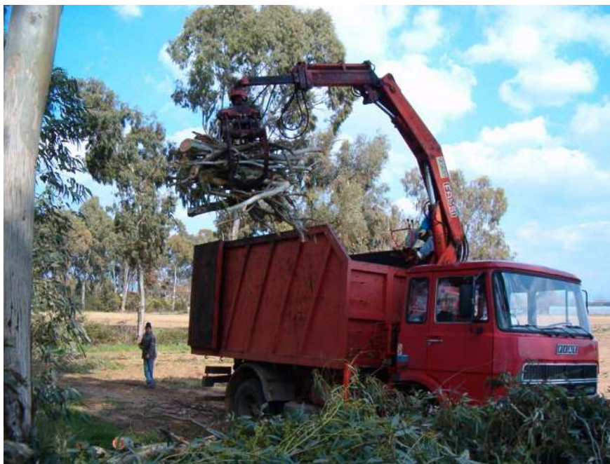
Foto 17 – Carico della legna da ardere di eucalipto con pinza idraulica
