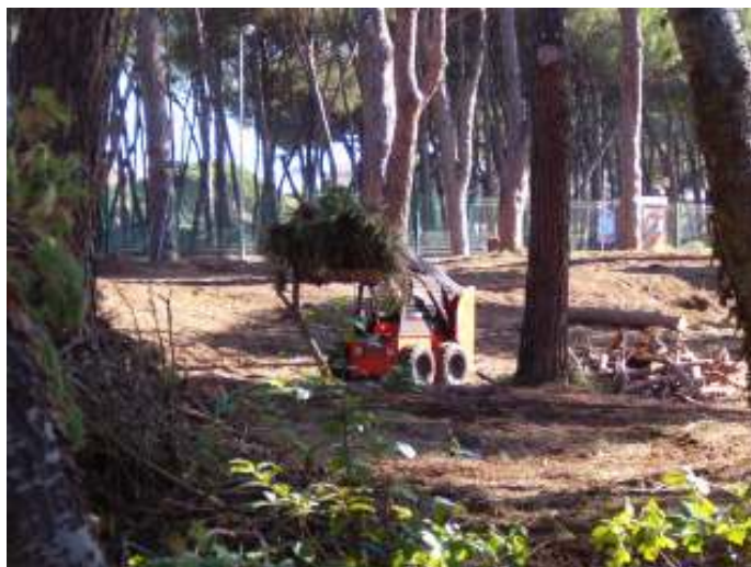
Foto 27 - Concentramento delle ramaglie di pino domestico con bobcat
