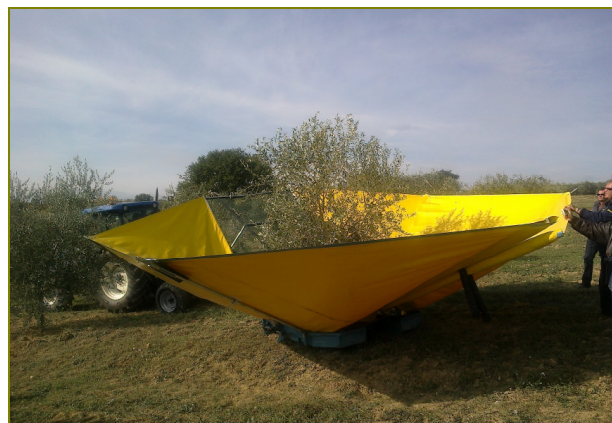
Raccolta meccanica in un giovane oliveto intensivo con vibratore del tronco applicato su una trattoria ed abbinato ad un telaio intercettatore ad ombrello rovescio.
