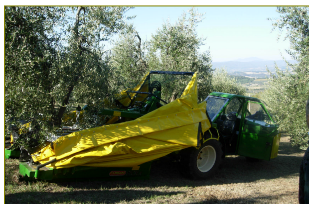
Raccolta meccanica un oliveto adulto intensivo con vibratore del tronco semovente dotato di un telaio intercettatore ad ombrello rovescio.
