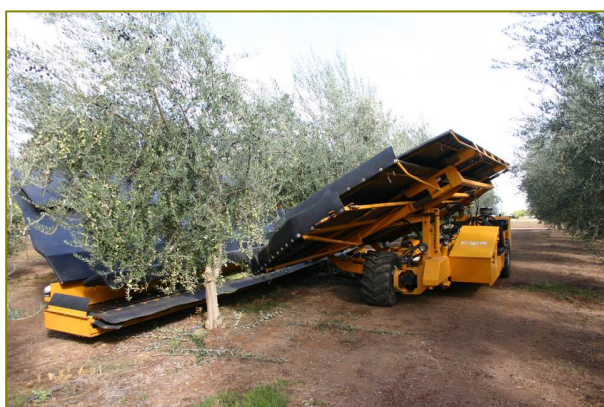
Meccanizzazione della raccolta con vibratore abbinato a telaio intercettatore laterale (Foto Ferguson).
