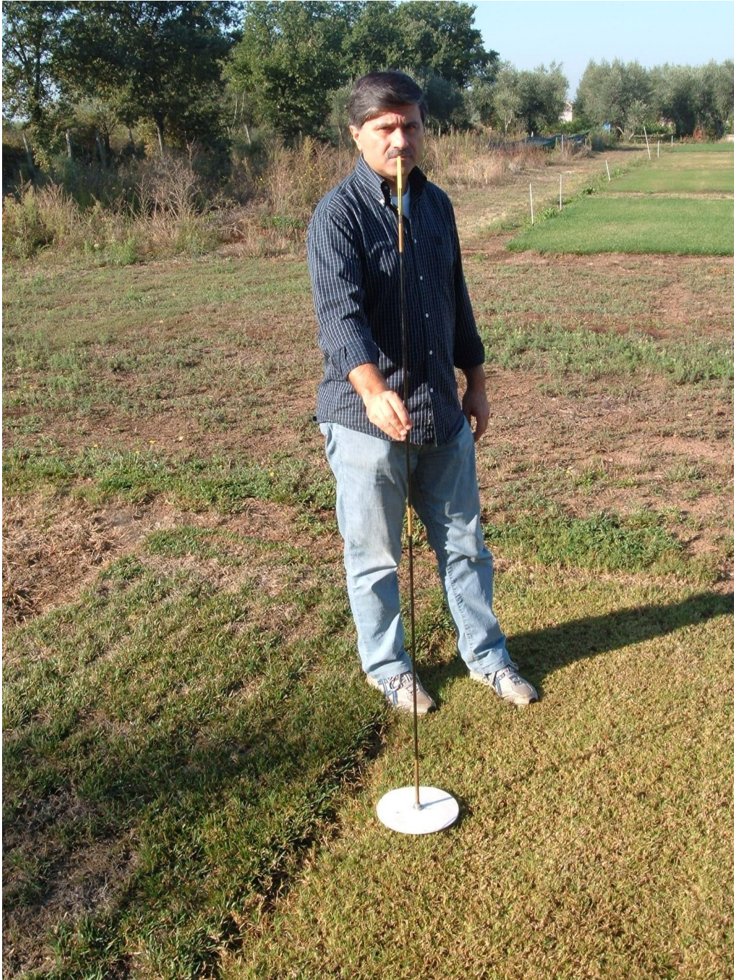
Fig. 2.8 – Un momento del rilievo delle altezze del tappeto erboso mediante lo strumento appositamente costruito (come si vede, la lettura avviene comodamente ad altezza d'uomo).
