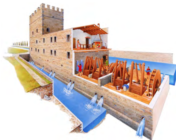
Schema del funzionamento delle gualchiere di Remole, tratto da IPOGEA 2009.
