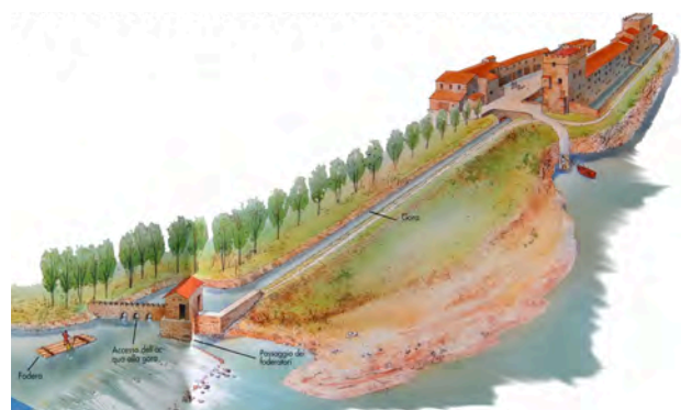
Disegno delle Gualchiere di Remole, con il canale che portava l'acqua, tratto da IPOGEA 2009.
