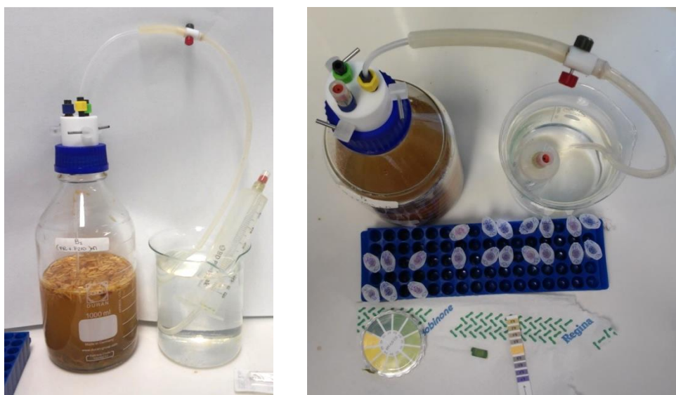
Figura 20. Misurazione tramite Water Displacement della quantità di biogas prodotto.
