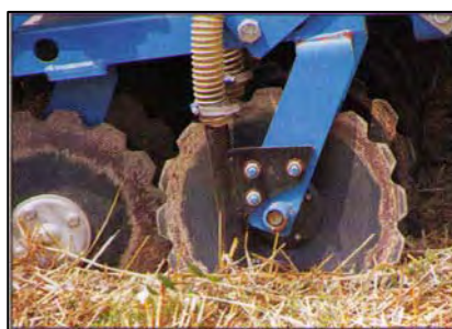
Figura 68: Seminatrice a righe con assolcatore a disco singolo e chiudi solco a ruota gommata indipendente.
