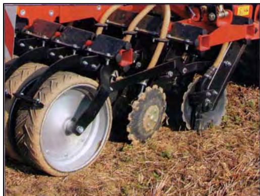
Figura 58: La profondità di semina è determinata da un parallelogramma articolato collegato al rullo gommato posteriore.
