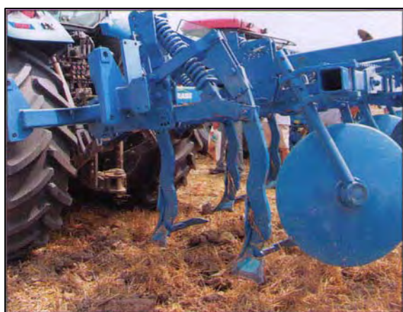
Figura 48: Coltivatore con ancore sigmoidali munite di sicurezza tipo non stop a molla, disposte su due ranghi, ed equipaggiate con utensile bombato e alette molto pronunciate
