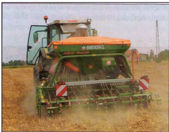
Figura 60: La combinata con erpice rotante garantisce un'ottima protezione del suolo.
