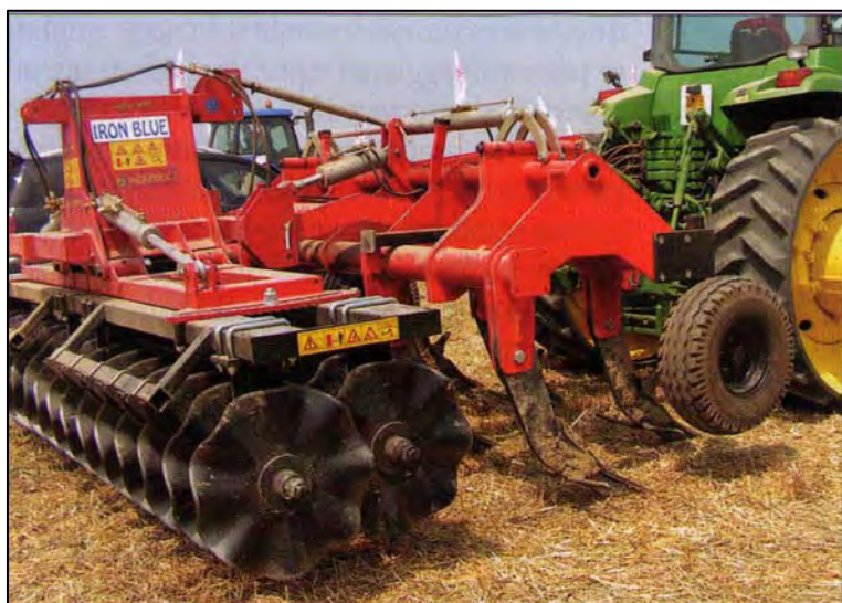
Figura 46: Esempio di coltivatore pesante equipaggiato con ancore inclinate in avanti; si notino le ruote di profondità e il doppio rullo a dischi ondulati, molto aggressivo sulle zolle.
