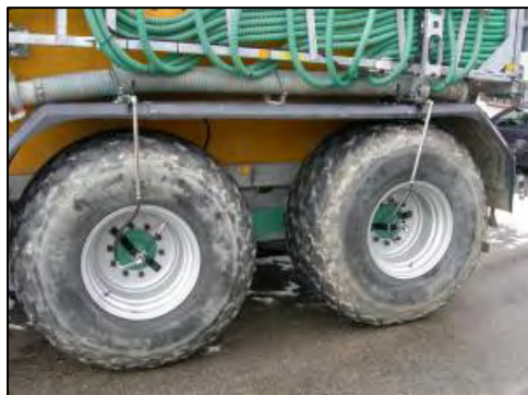
Figura 22: Sistema per la regolazione della pressione
