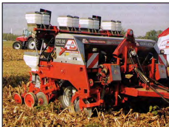
Figura 67: Seminatrice di precisione caratterizzata da un elemento di semina munito solo degli utensili fondamentali.
