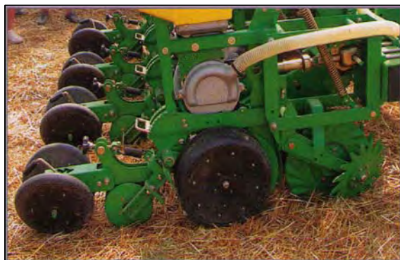
Figura 64: Esempio di elemento di semina corredato di organi destinati all'allontamento del residuo, alla preparazione del solco, alla deposizione del seme, alla copertura e infine alla chiusura del solco di semina.
