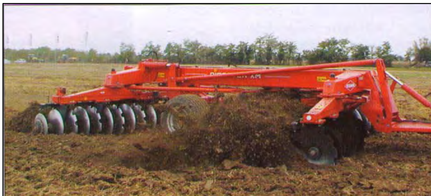
Figura 52: Erpice a dischi caratterizzato da un'elevata velocità di lavoro
