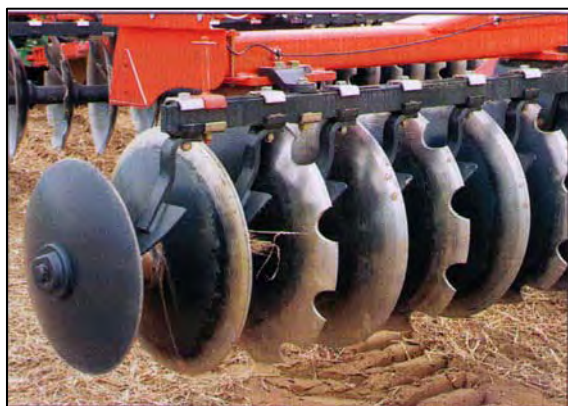
Figura 53: Esempio di dischi lisci e dentati disposti in modo alternato in erpice convenzionale.
