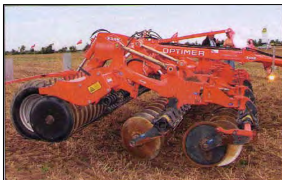
Figura 54: Erpice a dischi indipendenti ottimizzato per eseguire lavorazioni superficiali e caratterizzato da una migliore gestione del residuo colturale.
