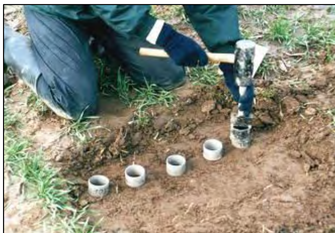
Figura 77: Campionatura con cilindri
