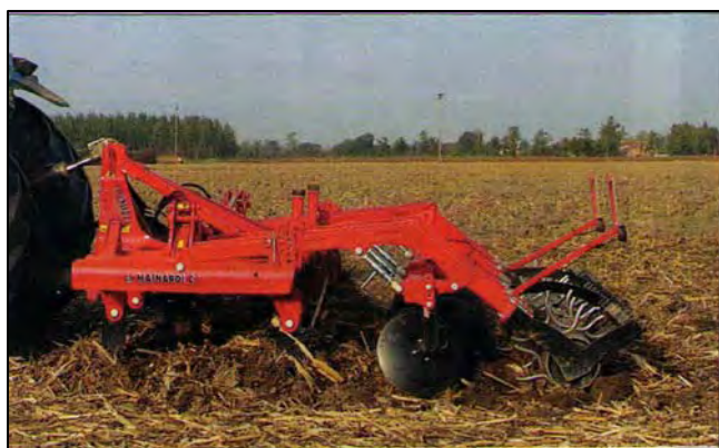
Figura 44: Lavorazione condotta a 33 cm profondità e velocità di 6,5 km/h con coltivatore ad ancore dritte e piede con alette pronunciate.
