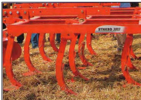
Figura 50: Coltivatore con ancore quasi dritte, disposte su tre ranghi, munite di piede a zampa d'oca larga e lama protettiva con curvatura poco pronunciata.
