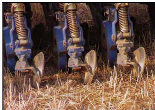
Figura 72: Nella semina a righe è frequente il ricorso a chiudisolco costituiti da una ruota singola, in metallo, dotata di profilo conico.
