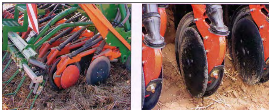
Figura 55: Esempi di organi assolcatori idonei ad operare su terreno blandamente preparato. Il secondo disco, più piccolo, protegge il corpo seminatore e funge da limitatore della profondità, può essere in materiale plastico.
