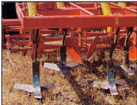
Figura 49: Le alette molto pronunciate consentono di ridurre il numero delle ancore. Tutto il fronte di lavoro è interessato al sollevamento prodotto dalle alette.
