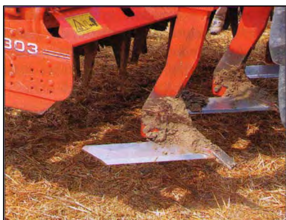
Figura 62: Utensile a larga zampa d'oca che provvede a sollevare il terreno.
