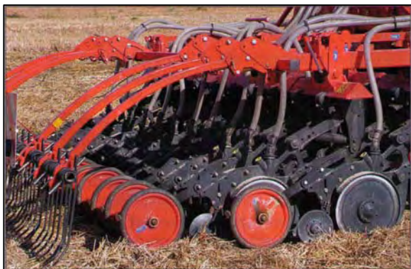
Figura 71: In questa seminatrice a righe all'assolcatore a doppio disco segue un piccolo disco convesso e in metallo che effettua una prima chiusura del solco seguita da una ruota con profilo gommato munita di raschiafango
