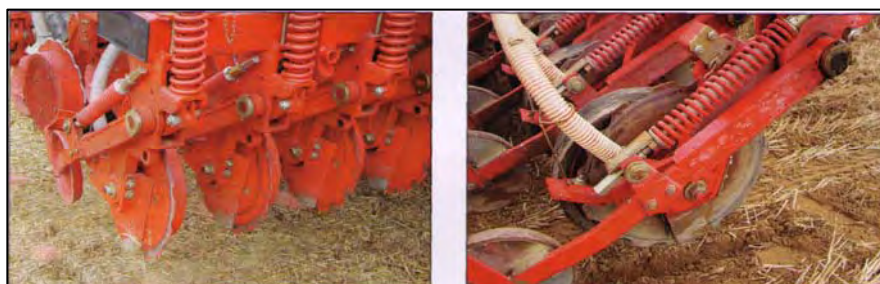
Figura 69: Esempi di elemento per la semina a righe composti da un assolcatore a disco singolo con ruota di profondità in metallo e in gomma e chiudi solco a ruota singola.
