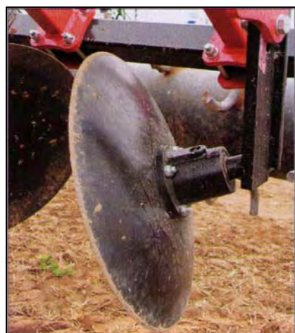
Figura 51: Posteriormente alle ancore sono sempre presenti degli organi disco con la funzione di colmare il solco.
