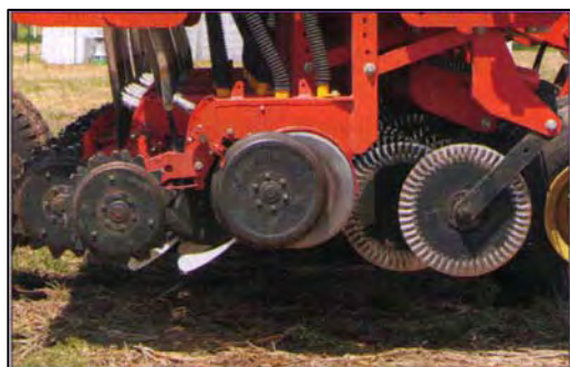
Figura 63: Seminatrice caratterizzata da una disposizione sfalsata degli elementi di semina.
