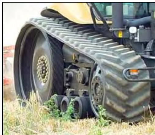
Figura 20: Cingoli in gomma per i trattori di elevata potenza.
