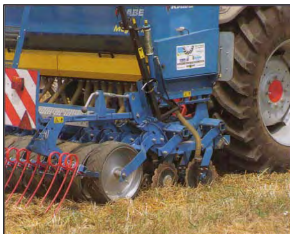
Figura 68: Seminatrice a righe con assolcatore a disco singolo e chiudi solco a ruota gommata indipendente.
