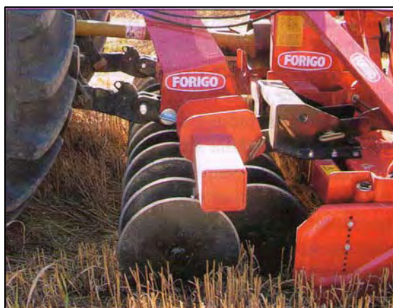
Figura 61: I dischi tagliando il residuo colturale evitano problemi di ingolfamento.
