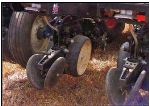
Figura 70: Seminatrice di precisione con assolcatore a doppio disco munito di ruote di profondità in gomma e chiudi solco con profilo in gomma.
