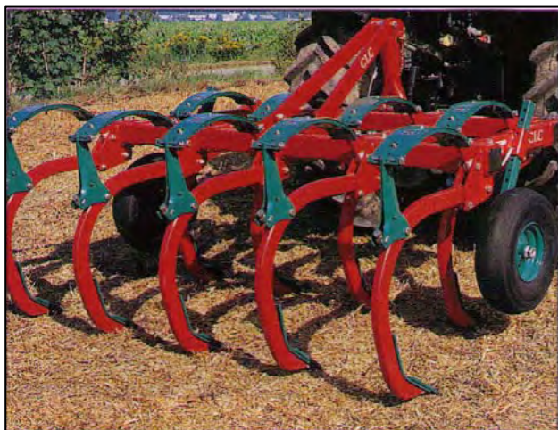
Figura 45: La parte dell'ancora che opera fuori terra è ricurva, mentre la parte che penetra nel terreno acquista un profilo quasi verticale per evitare un eccessivo rimescolamento.
