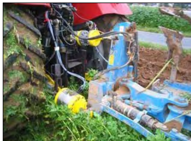
Figura 74: (sinistra) Attacco a tre punti sensibilizzato (RAGNI e SANTORO, 1996 a, b); (destra) Attacco a tre punti sensibilizzato (Centro Prove DLG, 2004)
