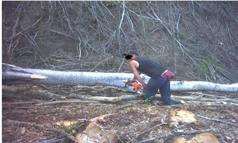
Foto 7: la barra della motosega resta incastrata nel fusto perché usata in maniera non corretta dall'operatore
