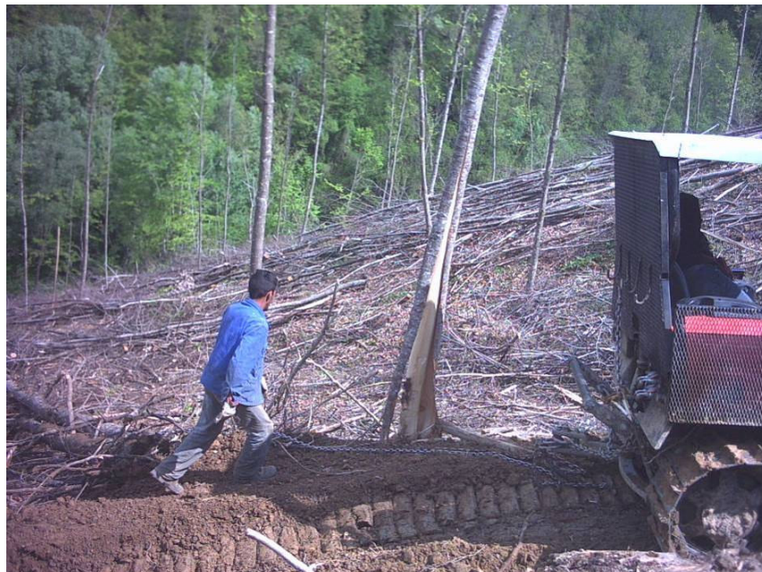
Foto 39: matricina completamente scortecciata in fase di esbosco dai cingoli del trattore
