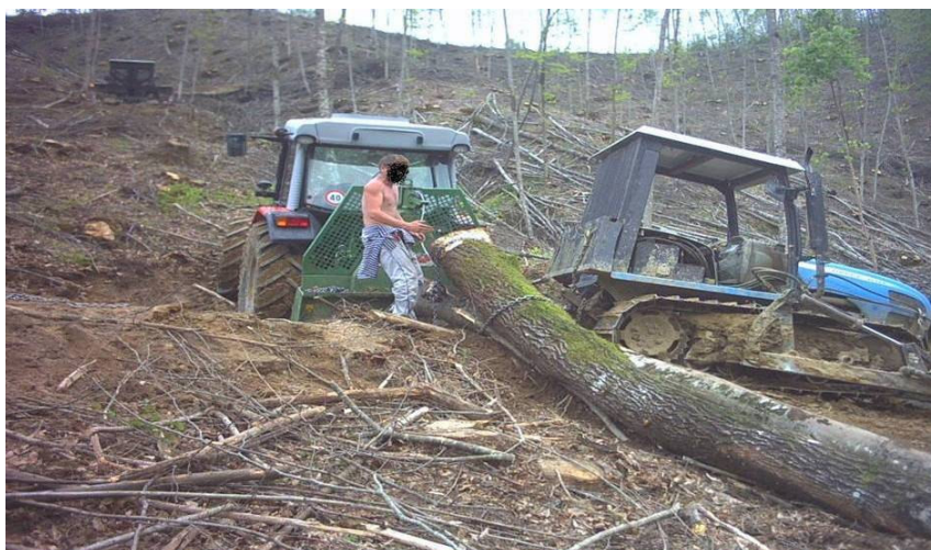
Foto 17: sia i mezzi che l'operatore sono privi di dispositivi di sicurezza, durante una operazione di concentramento alla pista con il verricello
