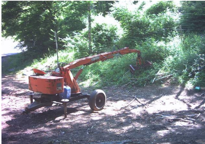
Foto 34: braccio idraulico alimentato dal trattore usato quando la legna doveva essere caricata sugli autotreni
