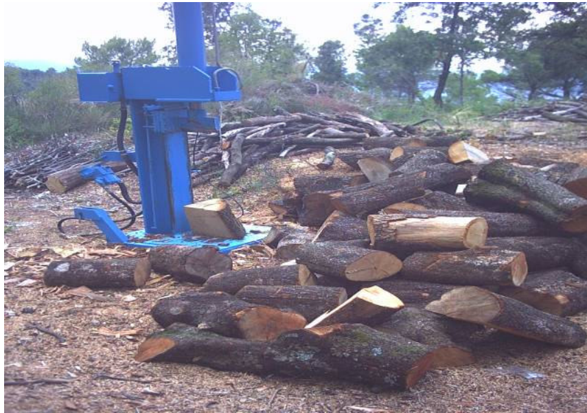
Foto 35: spaccalegna idraulico usato quando era necessario ridurre le dimensioni degli assortimenti
