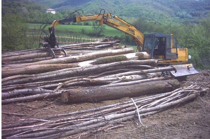
Foto 15: caricatore con braccio idraulico per la movimentazione dei tronchi all'imposto ed il loro carico
