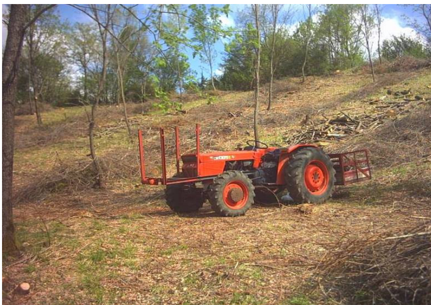
Foto 30: trattore agricolo con le gabbie per il trasporto della legna all'imposto; il mezzo è sprovvisto di protezione
