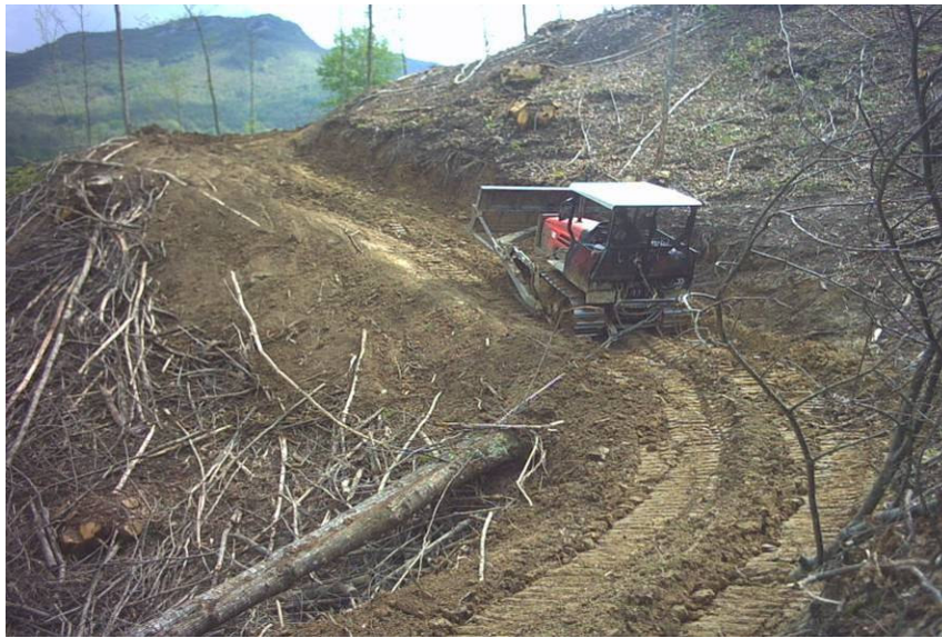
Foto 13: strascico del carico durante l'esbosco: la catena a strozzo viene agganciata al gancio di traino del cingolato
