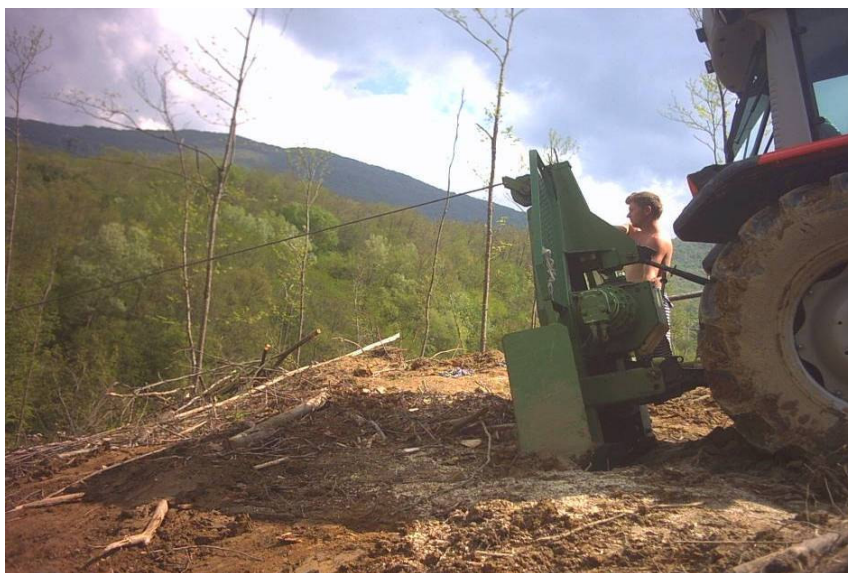
Foto 10: verricello forestale applicato al sollevatore idraulico del trattore agricolo a ruote in fase di strascico indiretto del carico
