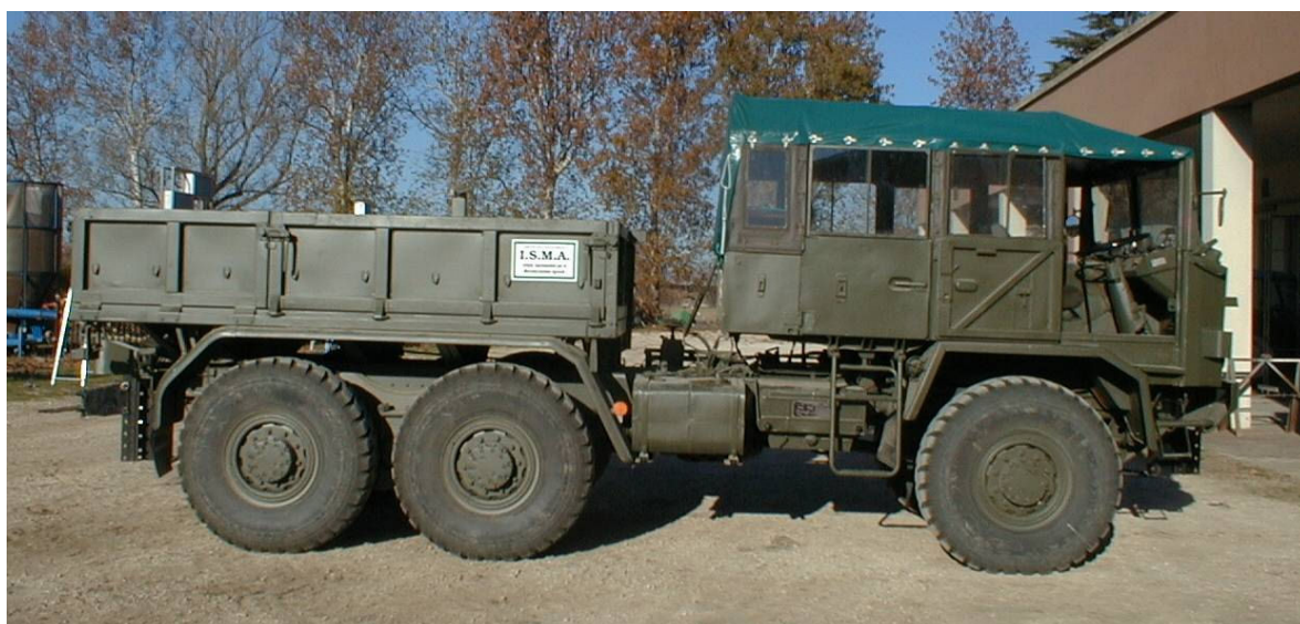
Figura V.1 - Carro freno per prove di autodislocamento in campo e su strada dei trattori agricoli.
