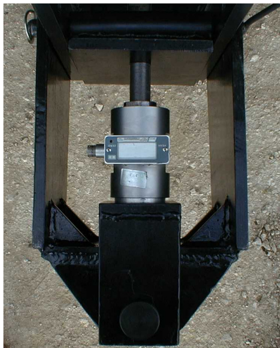
Figura V.4 - Cella di carico e struttura di supporto.
