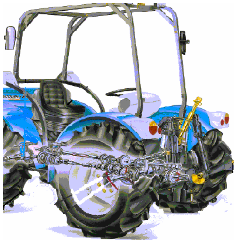
Figura I.26 - Collegamento della presa di potenza alla trasmissione.
