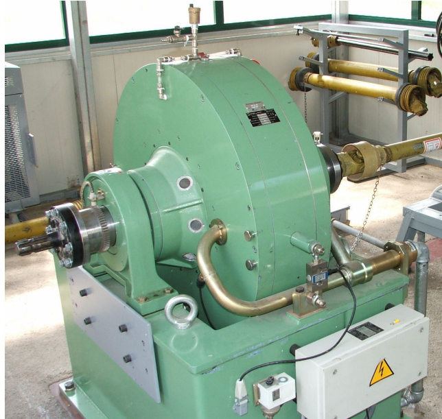
Figura IV.5 - Freno a correnti parassite Borghi & Saveri FE-600-S.
