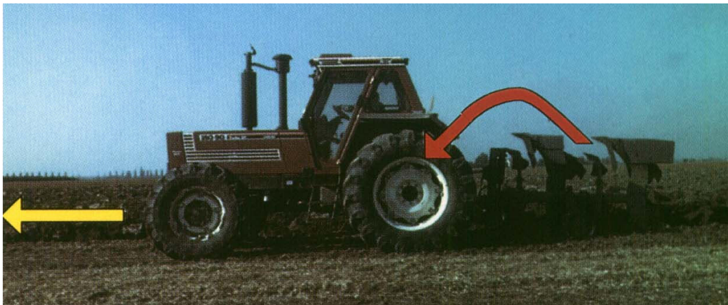
Figura III.8 - Durante le lavorazioni le sollecitazioni sul trattore sono trasferite dall'attrezzo a quest'ultimo.
