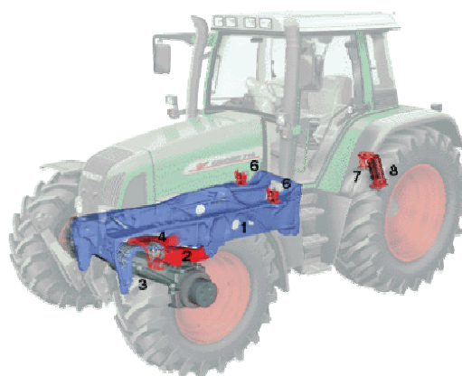
Figura I.13 - Chassis di un trattore: 1.telaio; 2.braccio oscillante; 3. assale oscillante; 4. cilindro idraulico; 5. ammortizzatori telaio; 6. supporti idraulici; 7. molle; 8. ammortizzatori cabina.
