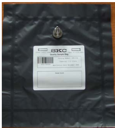
Figura 66 Sacca Tedlar utilizzate per il prelievo del syngas
