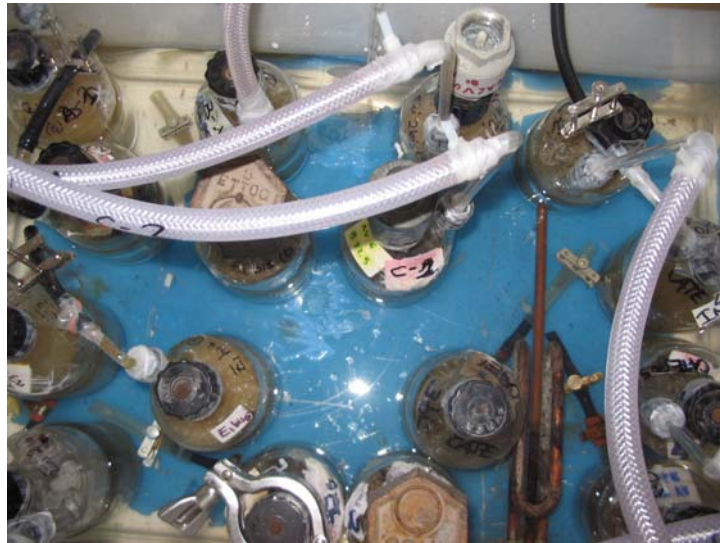
Figura 94 Zoom sui batch in digestione nel bagno termostatico
