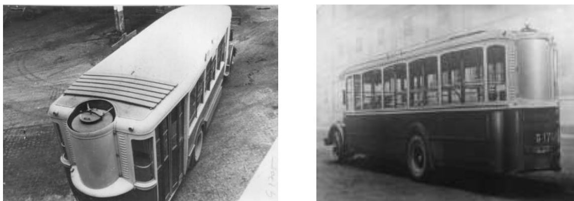
Figura 21: Gassificatori utilizzati per il trasporto pubblico durante la seconda guerra mondiale(1939-1945) [ 14]
