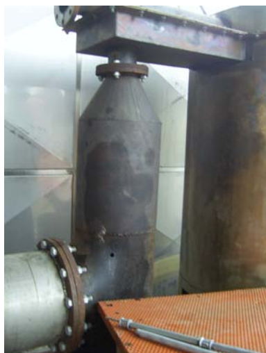
Figura 51 Schema del reattore di gassificazione
