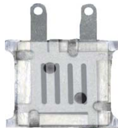
Figura 163: Immagine di una micro fuel cells da 20 mW.
