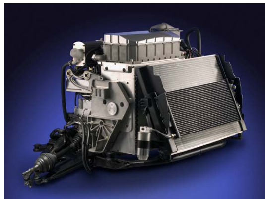
Figura 162: Immagina della Hydrogen 3 e del sistema di propulsione a celle a combustibile.
