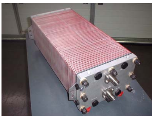
Figura 154 : Immagine di uno stack da 5kW costituito da 100 celle. Area frontale : 25 \times 18 cm.
