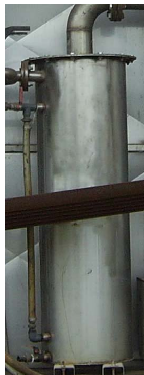
Figura 55 Schema e raffigurazione del gorgogliatore
