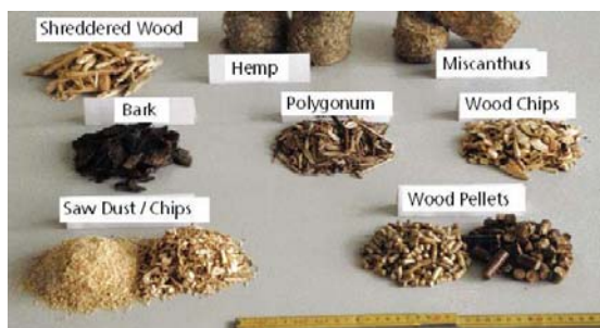
Figura 10 Forme e pezzature di biocombustibili solidi [5]
