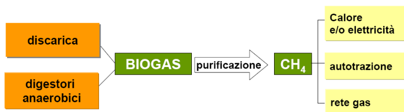
Figura 15 Produzione di biogas e suo utilizzo [10]
