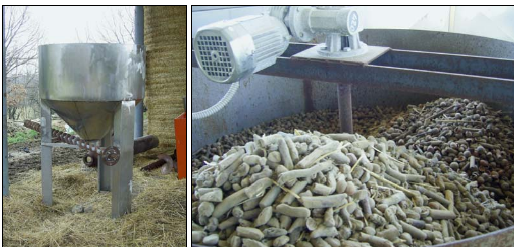
Figura 46 Tramoggia di carico della biomassa.
