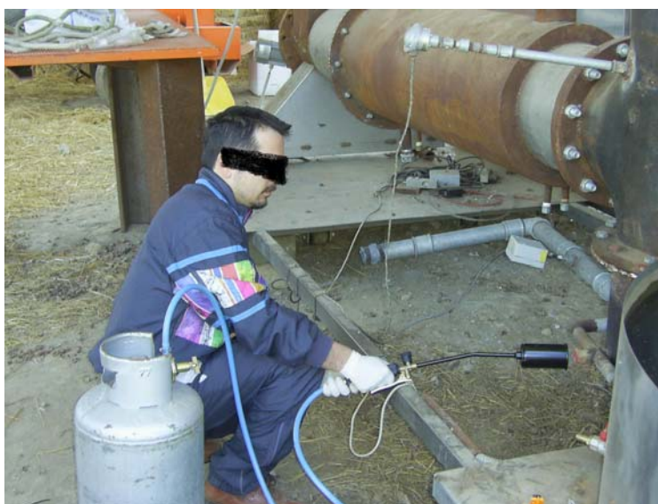
Figura 68 Energia fornita tramite torcia, per avviare la gassificazione.
