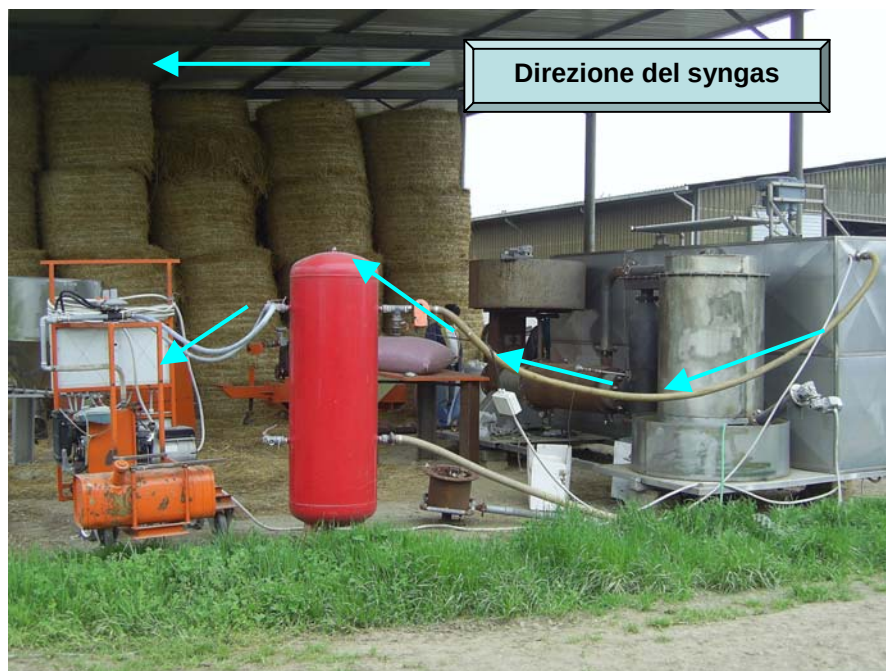
Figura 62 Impianto di gassificazione multi-reattore presente nell'azienda agro-zootecnica
