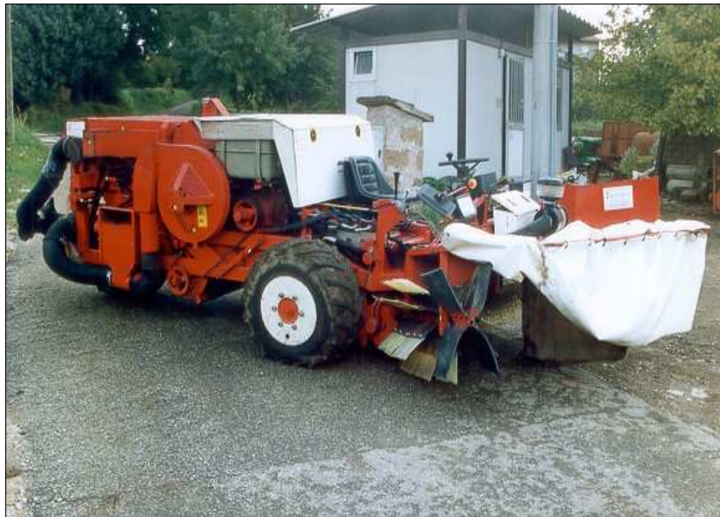
Foto 24 - raccattrice semovente 3 ruote motrici AGRINTEM "Perla 55"
