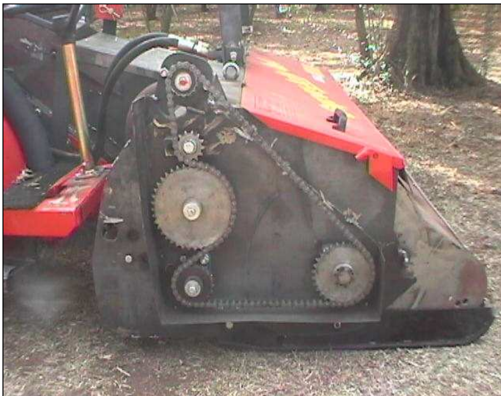
Foto 65- ingranaggi collegati tra loro mediante catena, posti sulla fiancata della macchina
