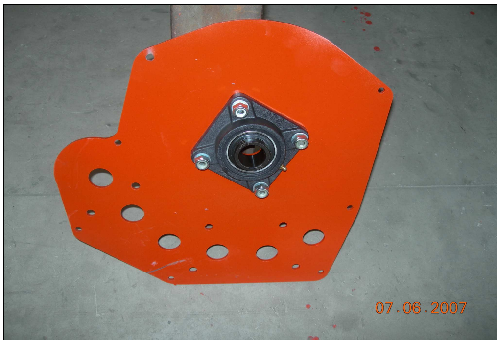
Foto 109 – la seconda piastra con i 6 fori per l'alloggiamento dei rulli defogliatori
