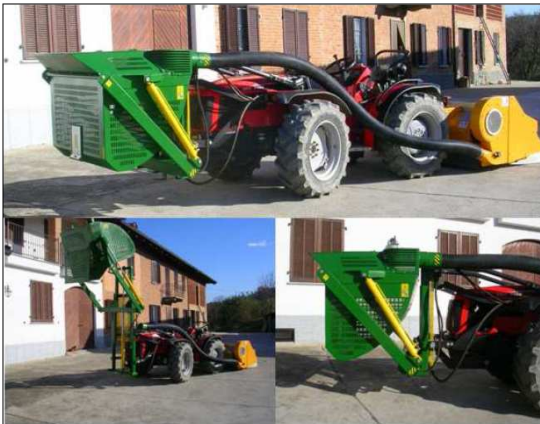
Foto 9 – un cantiere di lavoro completo: macchina raccoglitrice Rivmec, trattore A. Carraro guida reversibile mod. TRX 7400, cassone per stoccaggio e scarico della ditta Chianchia
