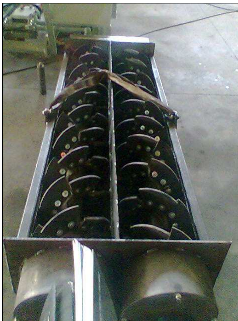
Foto 78 – la struttura delle camere di pulizia prima di essere montata sul carro semovente
