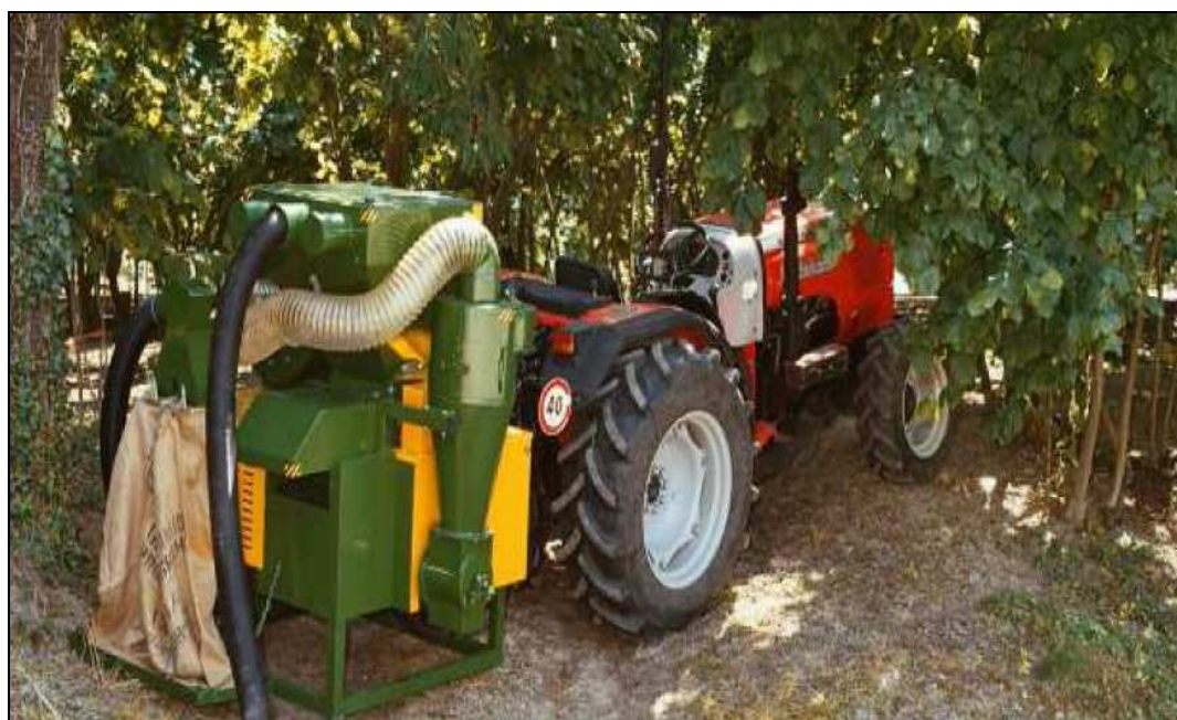
Foto 20 - la macchina aspiratrice portata prodotta dalla ditta Chianchia impiegata nella raccolta delle nocciole in Piemonte
