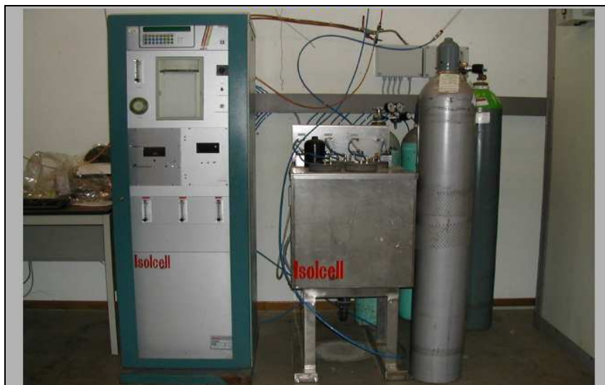
Foto 40 - analizzatore per monitoraggio atmosfera [MENCARELLI ET AL., 2007]
