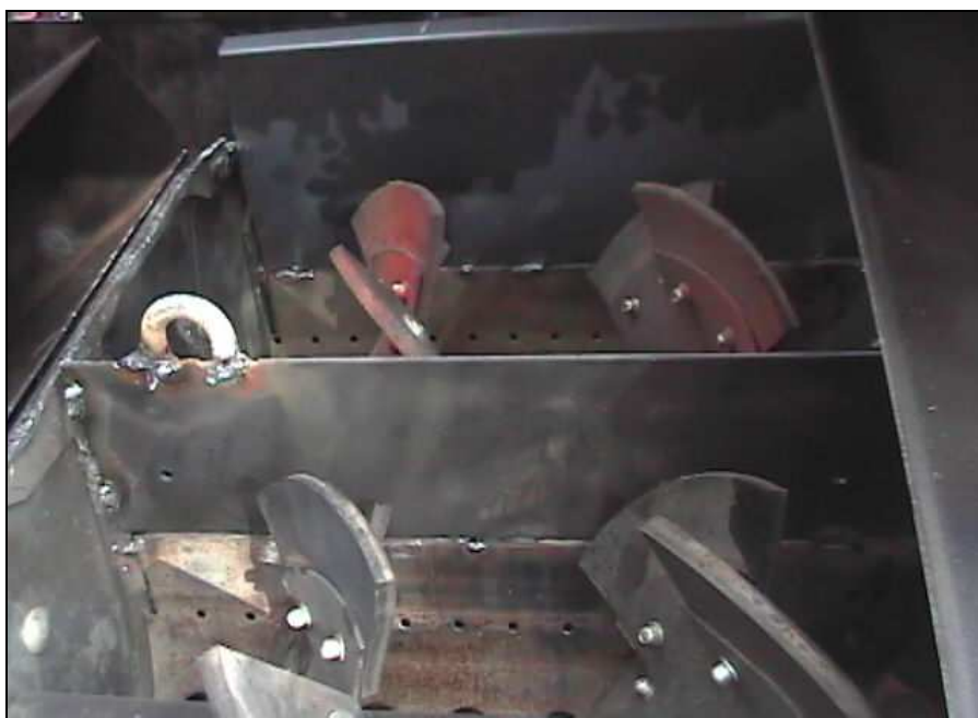
Foto 76 – particolare della bocca di entrata del prodotto nelle camere di pulizia superiori
