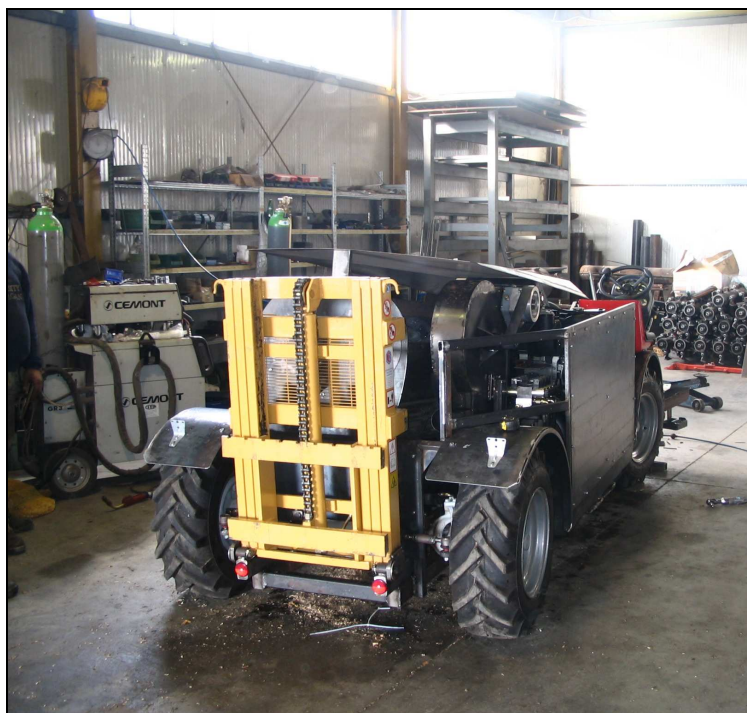
Foto 89 – il sollevatore posteriore per eventuali attrezzi e/o cassone ribaltabile, vista fronte lato
