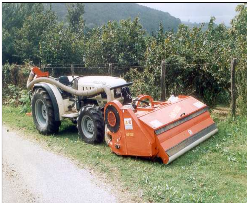
Foto 4 - macchina raccattatrice semiportata mod. Jolly 1800 su trattore non reversibile e presa di potenza idraulica per mezzo di Kit realizzato e fornito dalla stessa ditta
