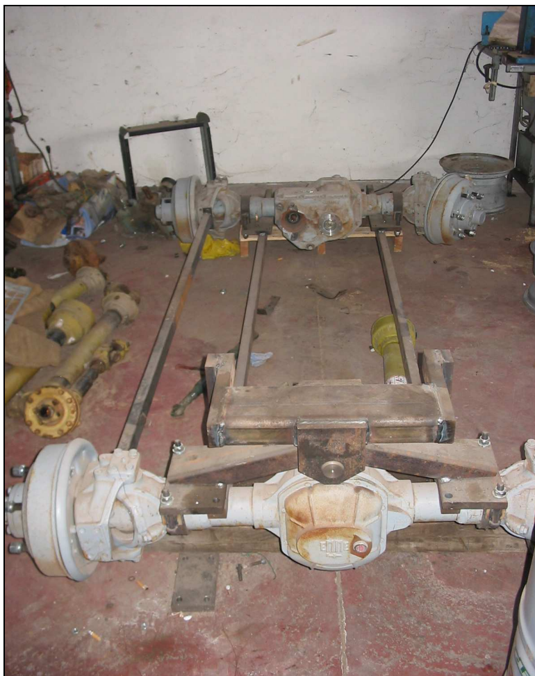
Foto 57- fasi iniziali di assemblaggio degli assali ad un telaio artigianale (anno 2005)
