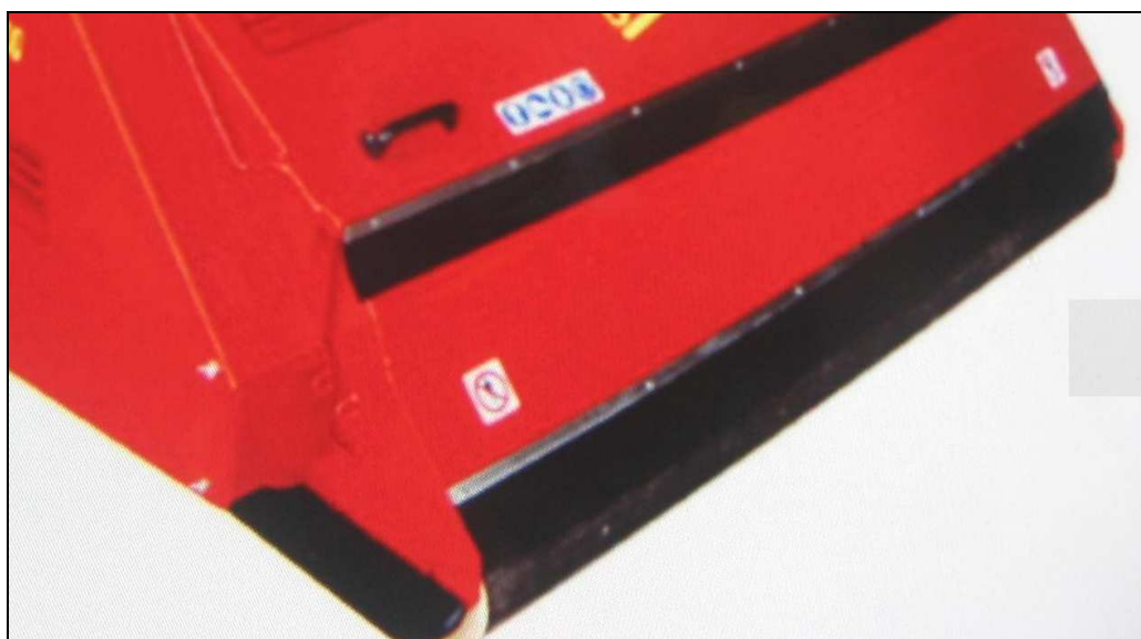
Foto 71 - rullo trasversale folle in PVC, segue l'andamento orografico del terreno
