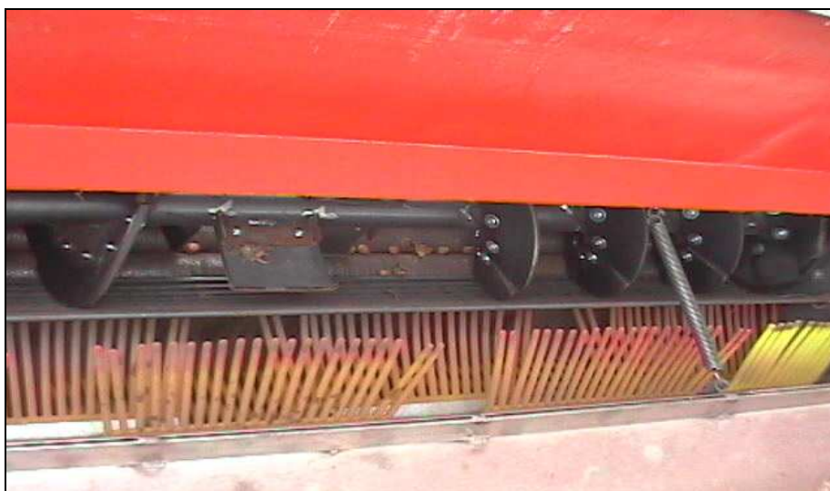
Foto 67 – la coclea primaria all'interno della testata di raccolta
