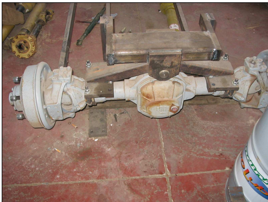
Foto 56- fasi iniziali di assemblaggio degli assali ad un telaio artigianale (anno 2005)
