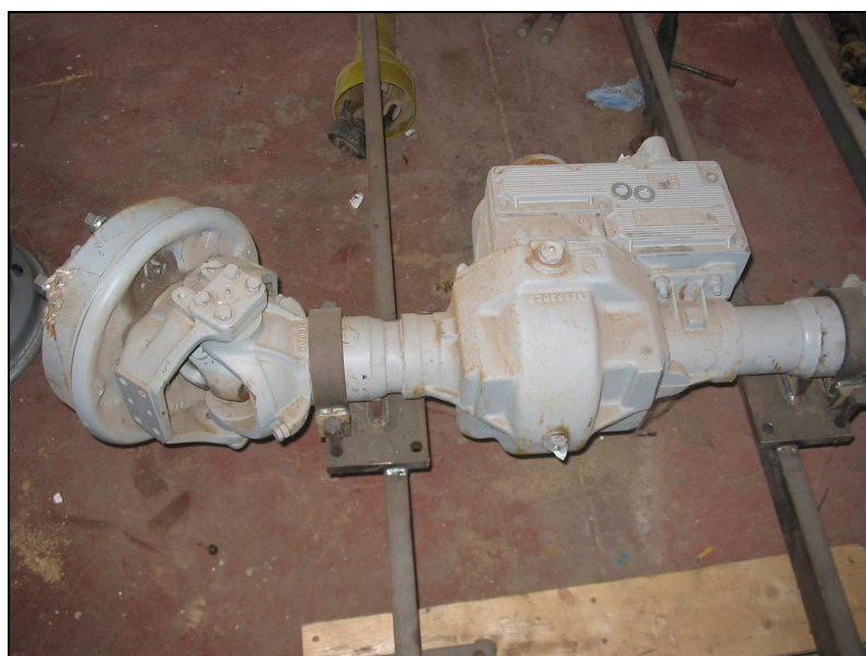
Foto 58 - posizionamento degli assali sul telaio del primo prototipo
