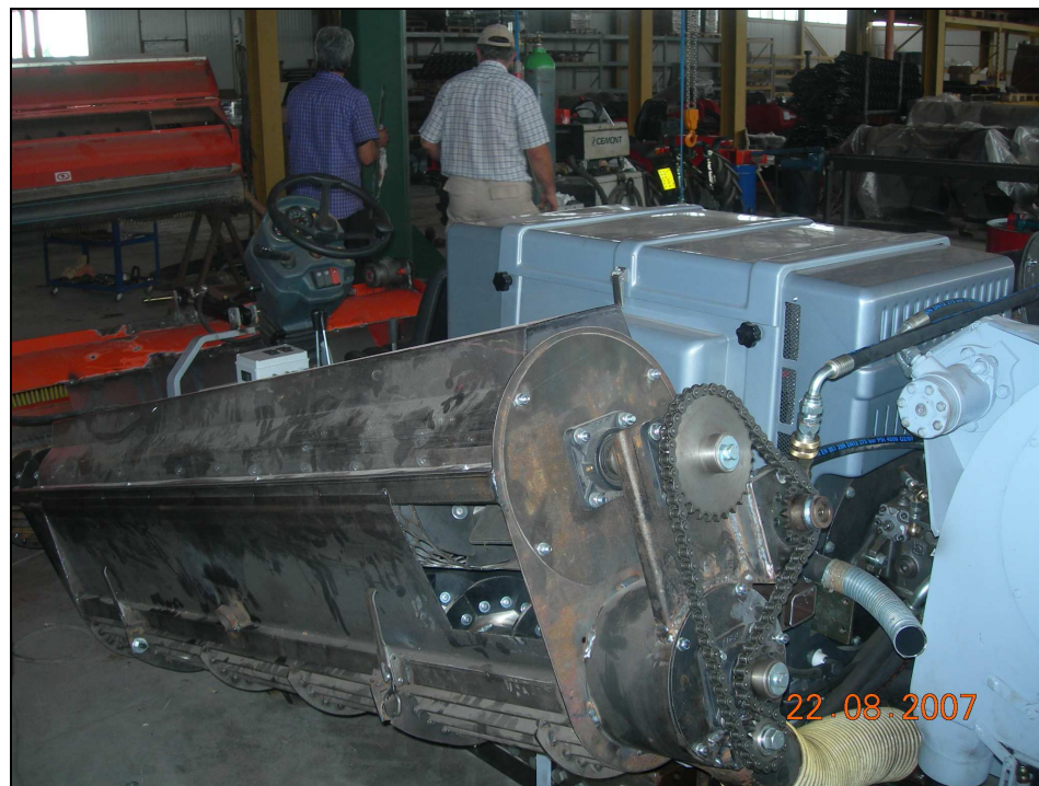
Foto 112 – le coclee e le camere di pulizia poste ai lati della macchina
