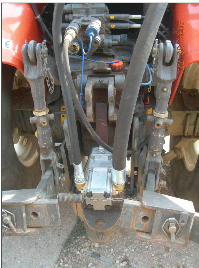
Foto 5 – pompa idraulica collegata alla p.d.p. posteriore della trattore
