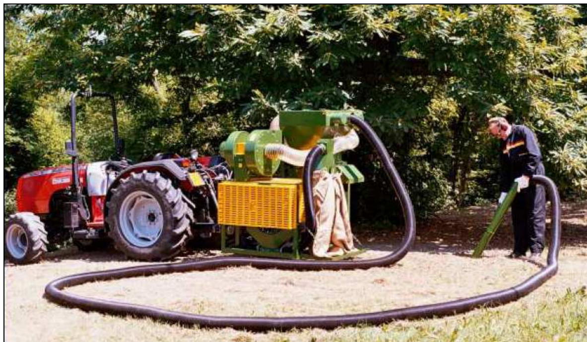
Foto 21 - la macchina aspiratrice portata prodotta dalla ditta Chianchia impiegata nella raccolta delle castagne in Piemonte
