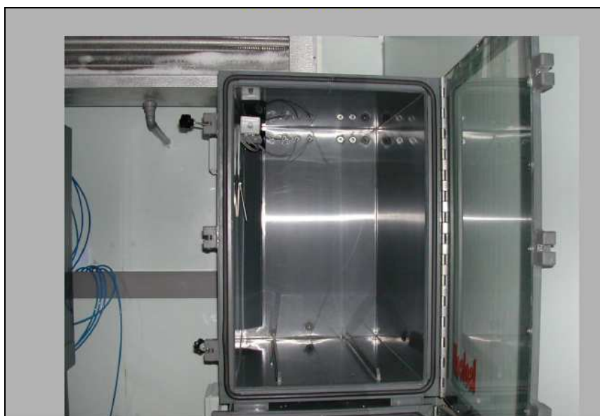
Foto 41 – contenitore simulante le condizioni nei silos [MENCARELLI ET AL., 2007]
