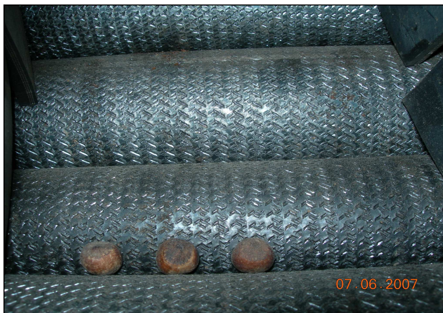
Foto 107 – le nocciole ora rotolano lambendo i rulli senza subire danni
