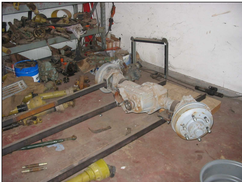
Foto 55 - fasi iniziali di assemblaggio degli assali ad un telaio artigianale (anno 2005)
