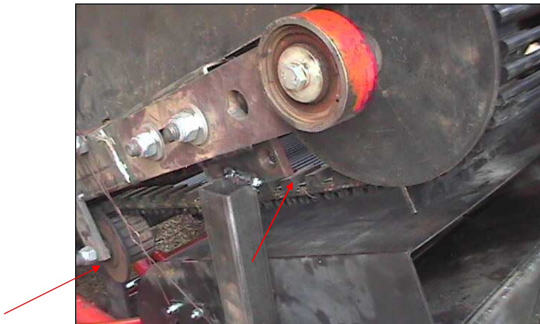
Foto 106 – il nuovo nastro trasportatore che ruota grazie ad un sistema di pulegge
