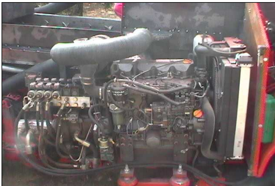
Foto 61 - il motore Yanmar nel primo prototipo: si noti la mancanza del vano motore insonorizzato (2005)
