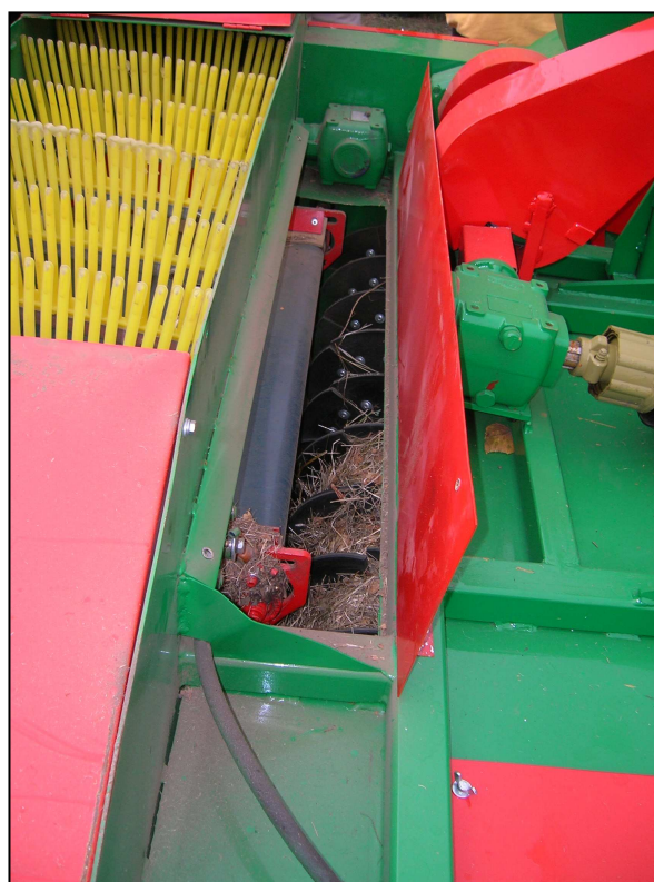
Foto 10 , 11 – macchina raccattatrice portata su trattore con guida reversibile prodotta dalla ditta GIAMPI di Corchiano (VT), mod. STAR 2000
