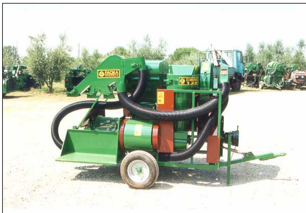
Foto13, 14 – aspiratrice FACMA Cimina 200 con e senza raccoglitore laterale
