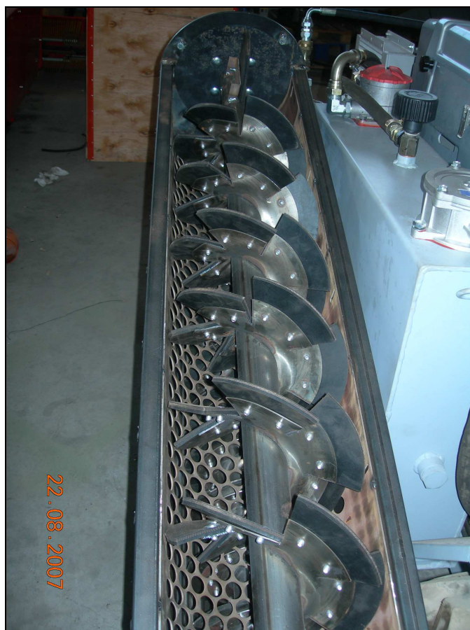
Foto 113 - la lunga coclea di trasporto e la rispettiva camera di pulizia cilindriche
