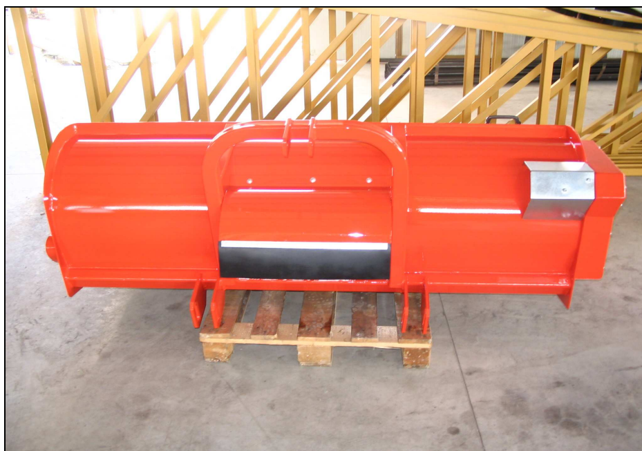
Foto 69 – la bocca centrale di alimentazione del nastro trasportatore
