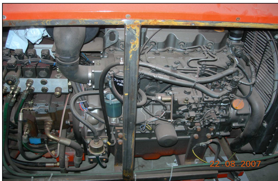
Foto 62 – il motore Yanmar all'interno del prototipo ed alloggiamento insonorizzato
