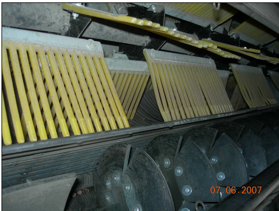
Foto 101 – particolare dei denti rinforzati sulle punte
