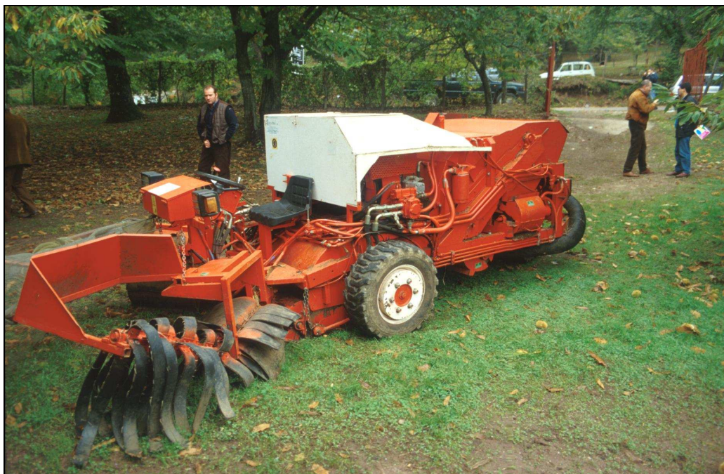
Foto 25 - raccattatrice semovente 3 ruote motrici AGRINTEM “Perla 55” in prova nei castagneti dei Monti Cimini
