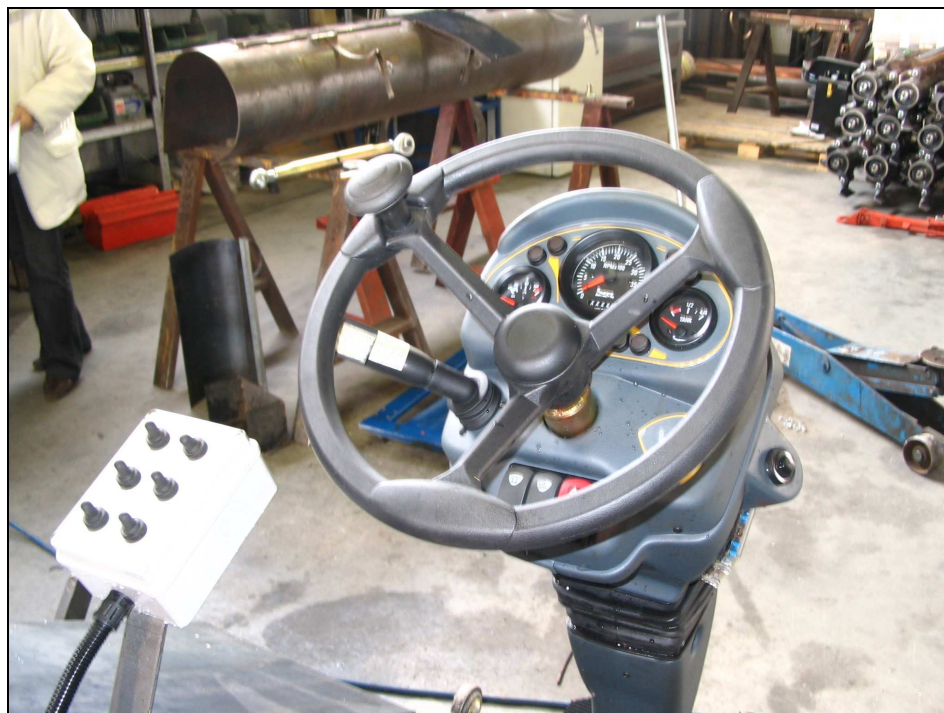
Foto 88 – lo sterzo completo di strumentazione, alla sua sx la scatola dei comandi per l'inversione del flusso idraulico per la scelta del tipo di sterzata
