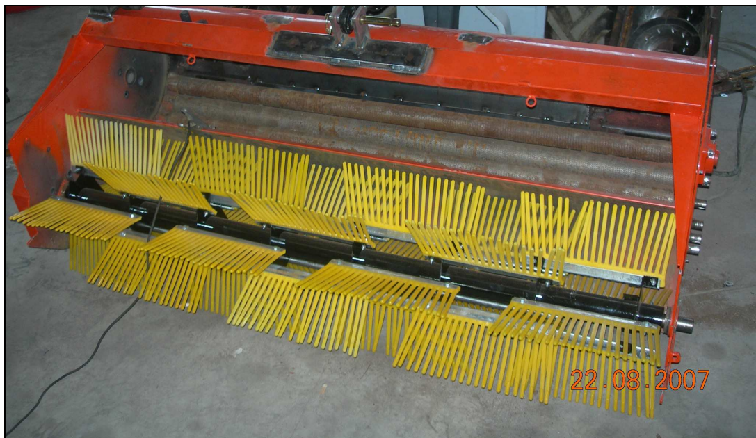
Foto 66 – La spazzola di raccattatura e la camera con i cilindri metallici all'interno della testata di raccolta
