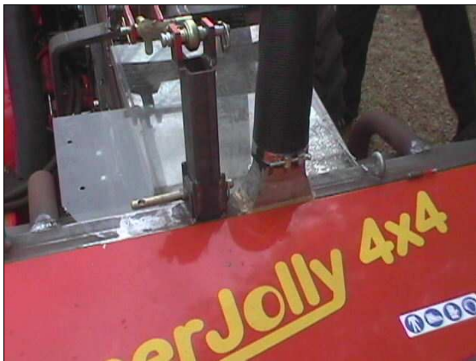
Foto 102 – (A) la nuova bocchetta di aerazione inserita sulla testata di raccolta
