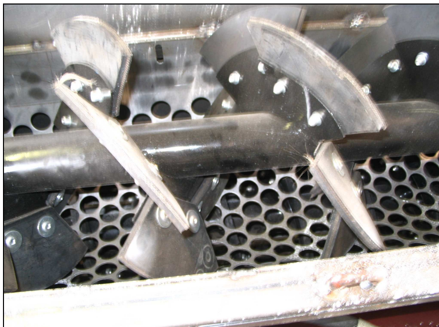
Foto 75 – particolare della coclea di trasporto e della parete forata della camera di pulizia
