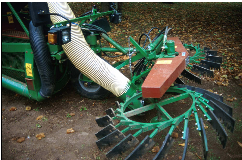
Foto 27 - Coppia di spazzole anteriori controrotanti e tubo di aspirazione.
