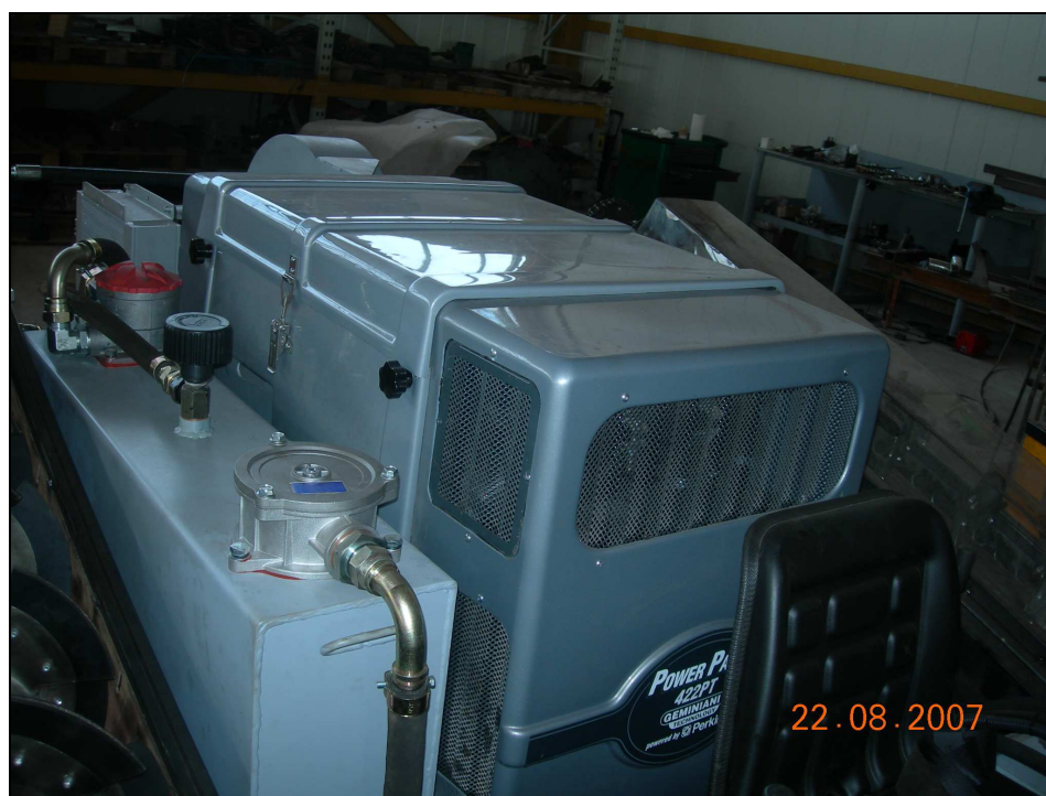
Foto 111 – il motore Perkins posto centralmente alle spalle del posto guida
