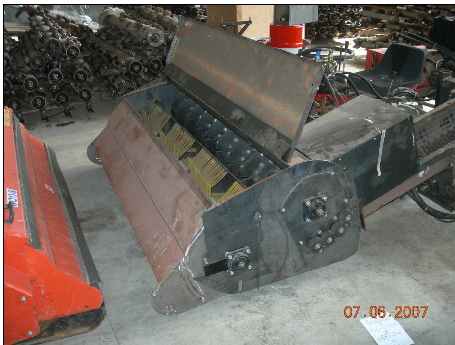
Foto 79 – assemblaggio della testata di raccolta al nastro trasportatore
