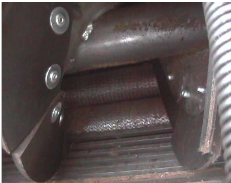
Foto 72 – particolare della griglia, della coclea con le palette in gomma e dei rulli defogliatori
