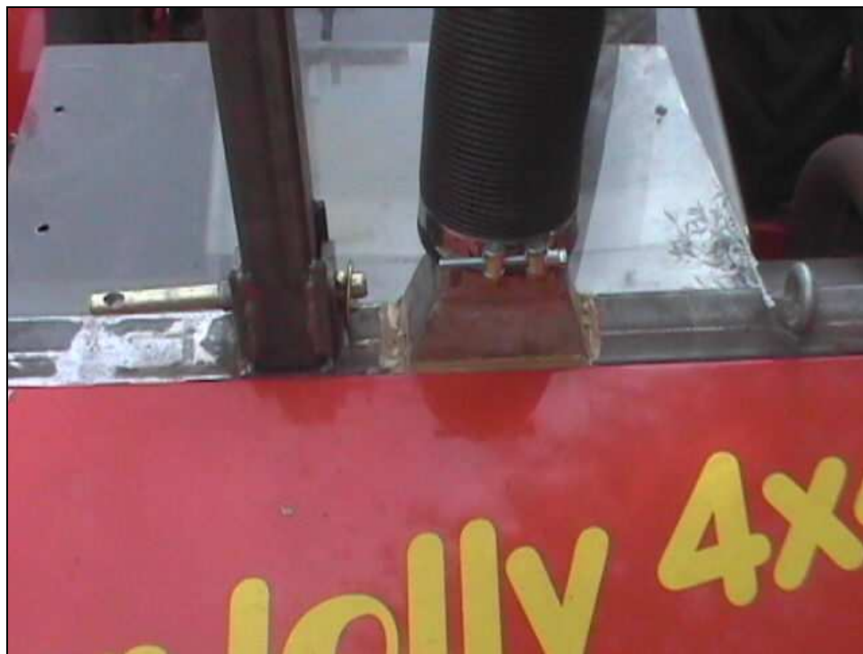
Foto 103 – (B) la nuova bocchetta di aerazione inserita sulla testata di raccolta
