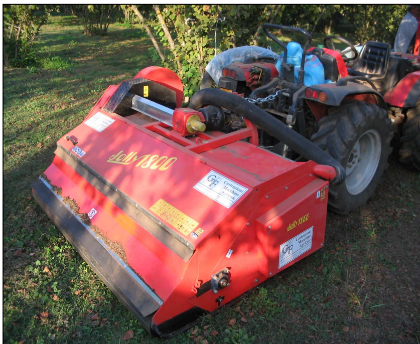
Foto 2 – macchina raccattrice semiportata mod. Jolly 1800 su trattore Carraro serie TRX - 9400 dotato di sistema di guida
