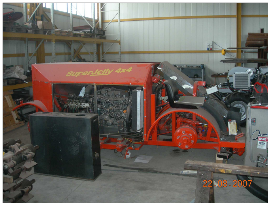
Foto 63 – il motore Yanmar nel vano motore insonorizzato (prototipo 2006/2007)
