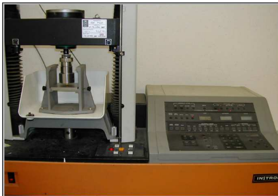
Foto 43 – strumento per analisi della durezza [MENCARELLI ET AL., 2007]
