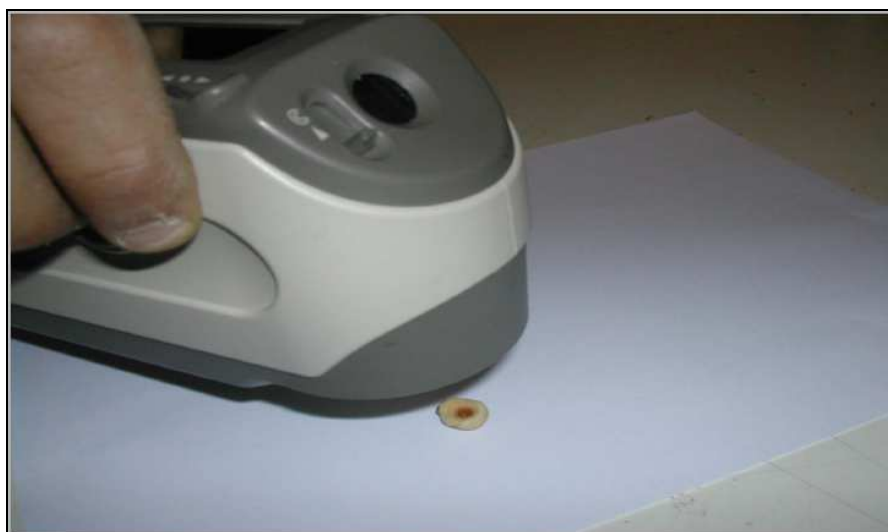
Foto 45 - analisi spettrocolorimetrica con attrezzatura ottica Minolta [MENCARELLI ET AL., 2007]
