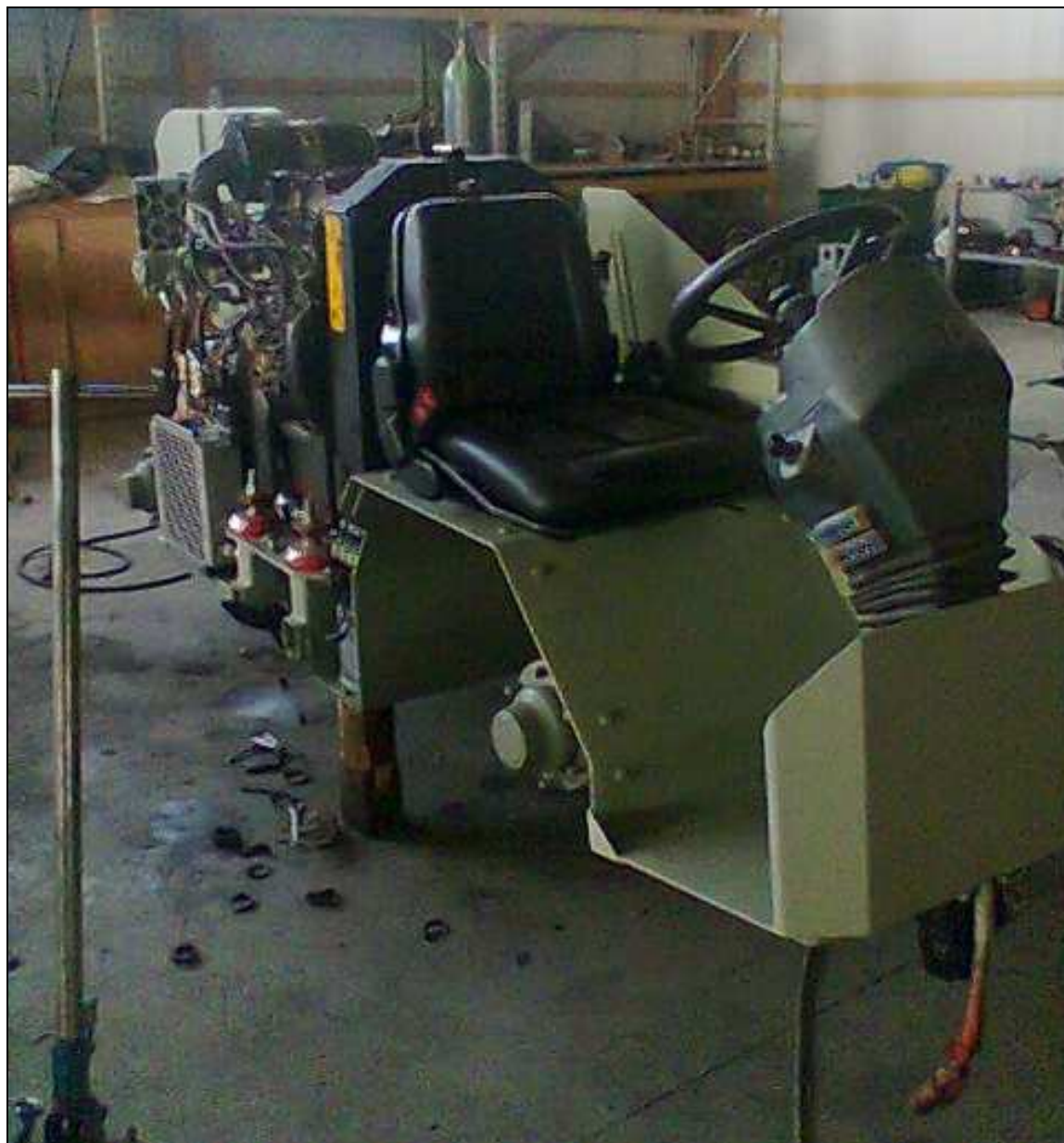
Foto 117 – il terzo prototipo: il nuovo telaio con posto di guida laterale
