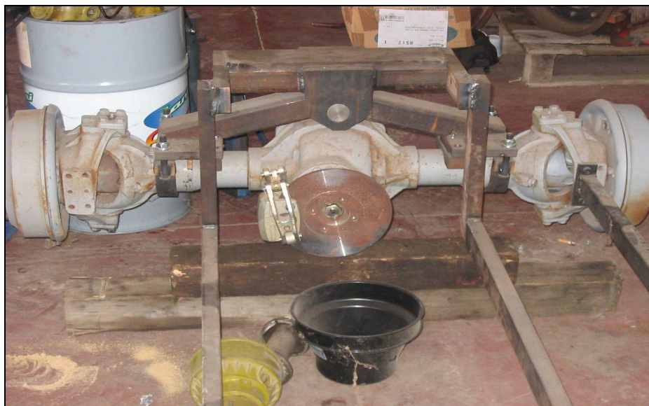
Foto 596 - fasi iniziali di assemblaggio degli assali ad un telaio artigianale (anno 2005)
