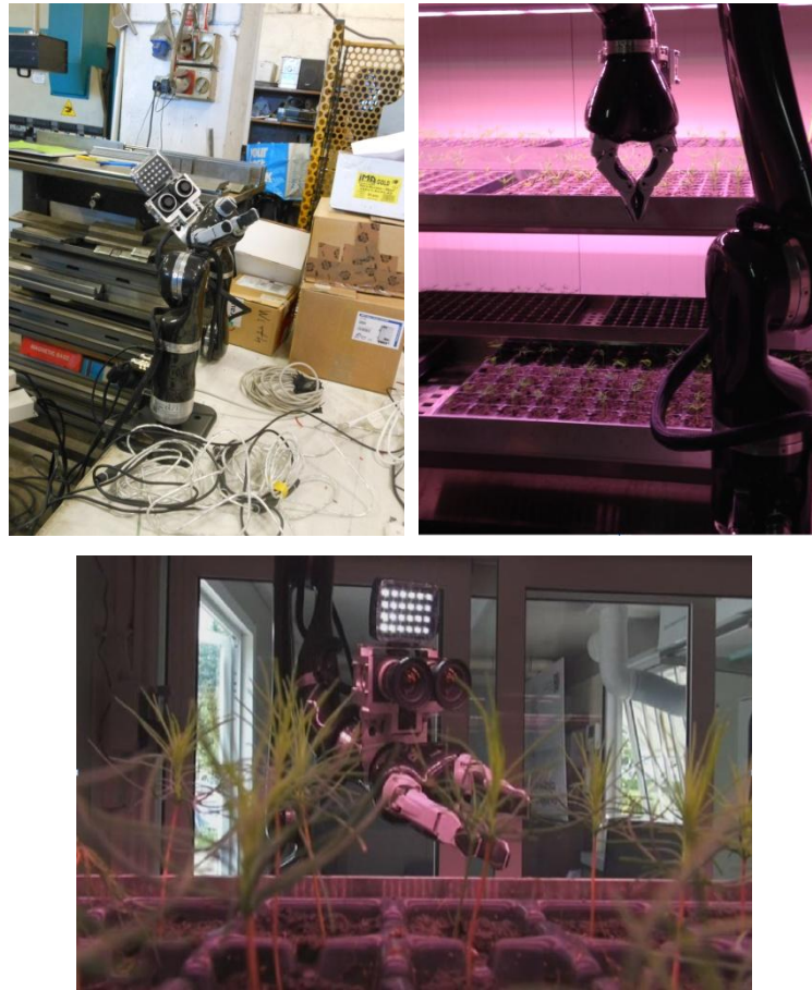
Figura 40. Braccio robotico prima e dopo il montaggio
