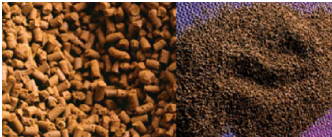
Figura 4.3: Bayoxide® E33, Materiale adsorbente per la rimozione dell'arsenico
