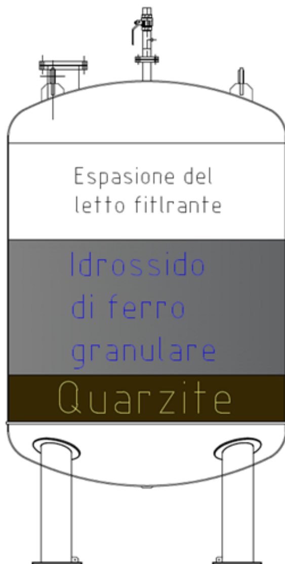
Figura 6.1: Fase riempimento masse filtranti
