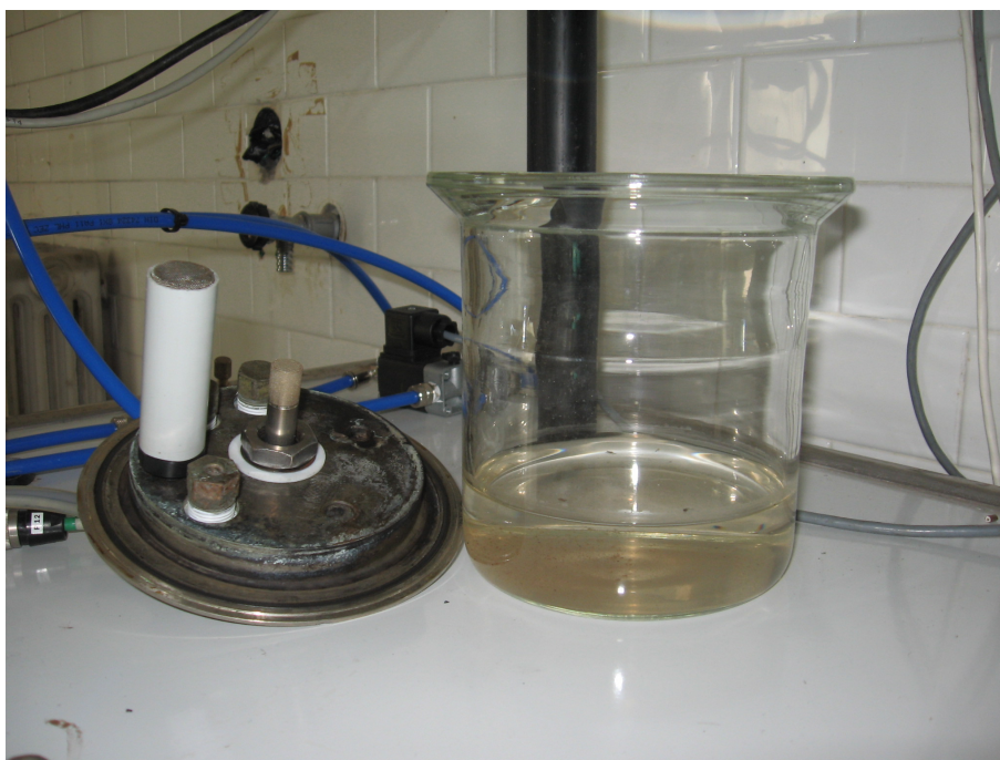
Foto 4.5 – Condenser sul cui coperchio sono posizionate le sonde. La sonda centrale misura la percentuale di ossigeno, la sonda bianca periferica misura l'umidità relativa (RH) e la temperatura esterna rilevata nel condenser (T1), che è la temperatura dell'ambiente esterno.
