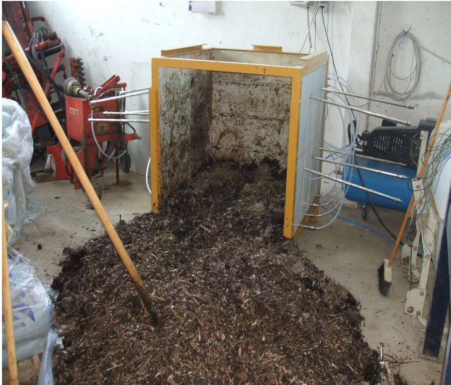
Foto 4.16 – Fase di svuotamento del bioreattore statico. Si notino i tubi per l’insufflazione dell’aria a diverse altezze.
