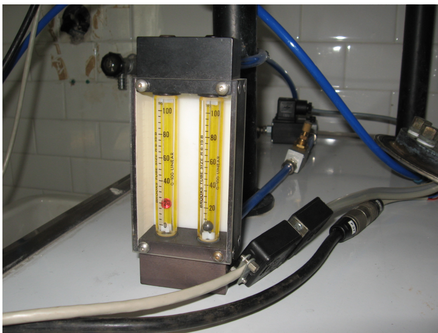
Foto 4.4 – I due flussimetri per la misura della portata dell'aria in ingresso nel cilindro.
