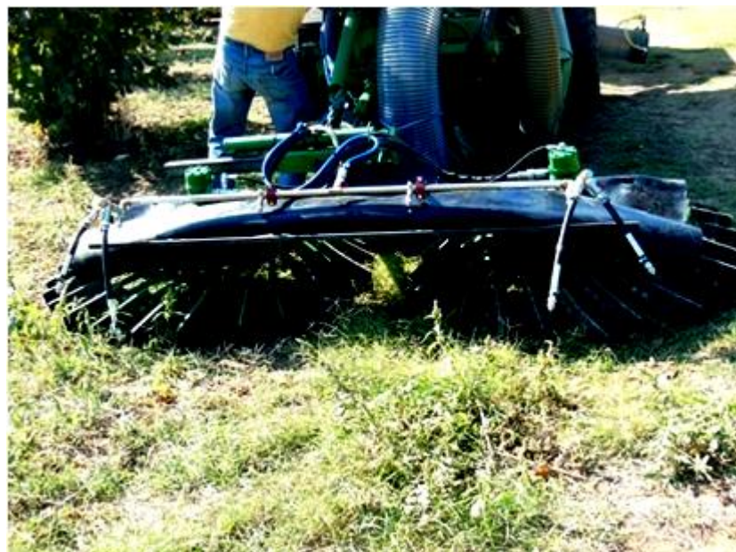
Foto13. Le “appendici” asimmetriche aggiunte alla barra anteriore
