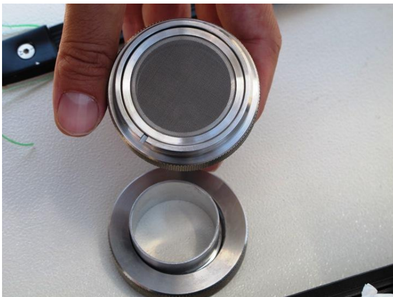
Foto 2. Portafiltro per il campionamento delle polveri totali
