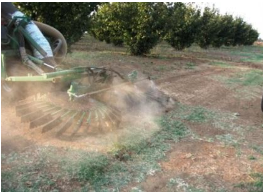
Foto 9. La barra irroratrice posta al di sopra delle spazzole
