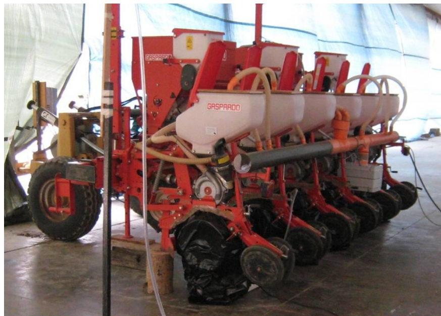
Foto 4. La seminatrice modificata nella configurazione prototipale P2.
