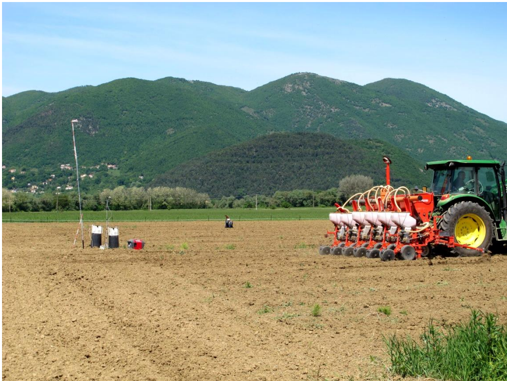
Foto 5. disposizione dei captatori dell'aria a bordo campo durante le prove di semina con la seminatrice modificata.
