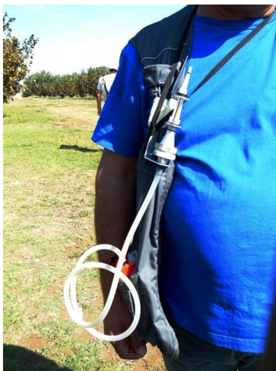
Foto 12. Ciclone Dorr-Oliver sull'operatore poco prima di una prova.
