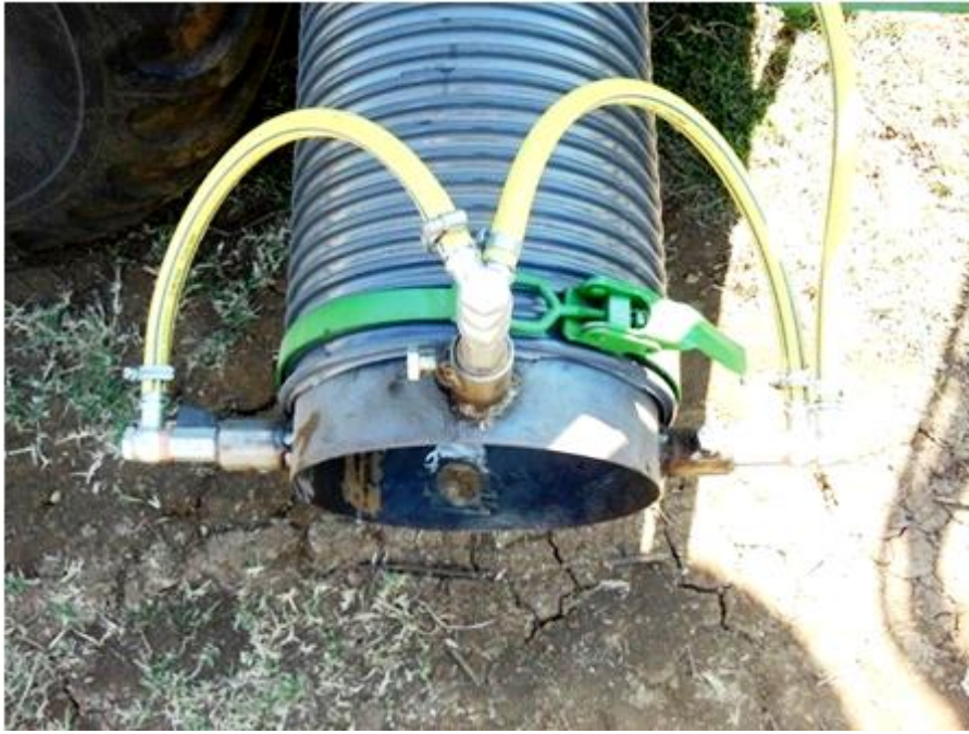
Foto 14. Gli ugelli posti attorno al tubo di scarico
