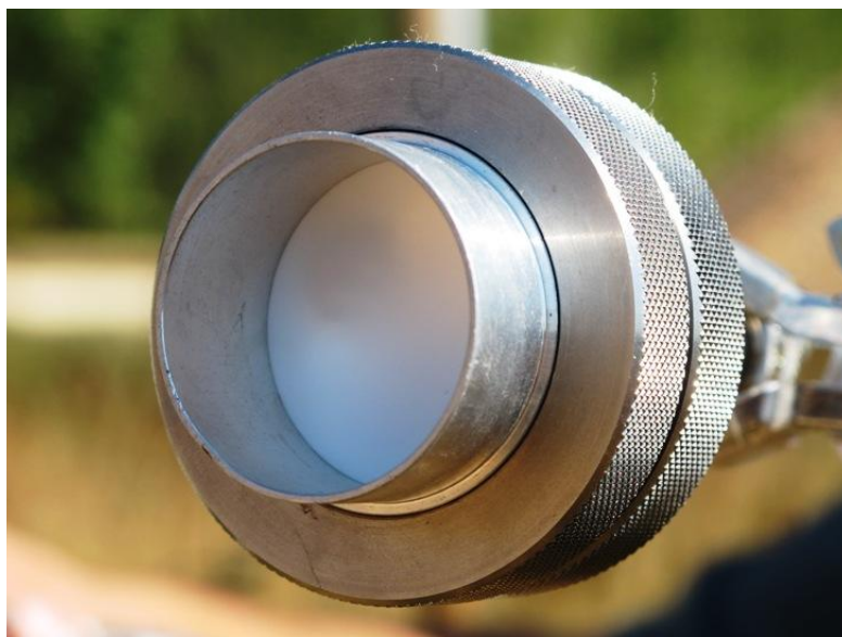
Foto 3. Filtro montato su portafiltro, senza testa di taglio, durante il campionamento
