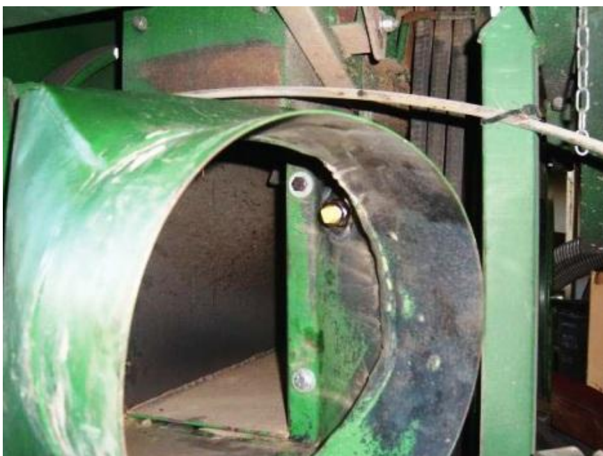
Foto 10. L'ugello per l'abbattimento all'interno del tubo di scarico
