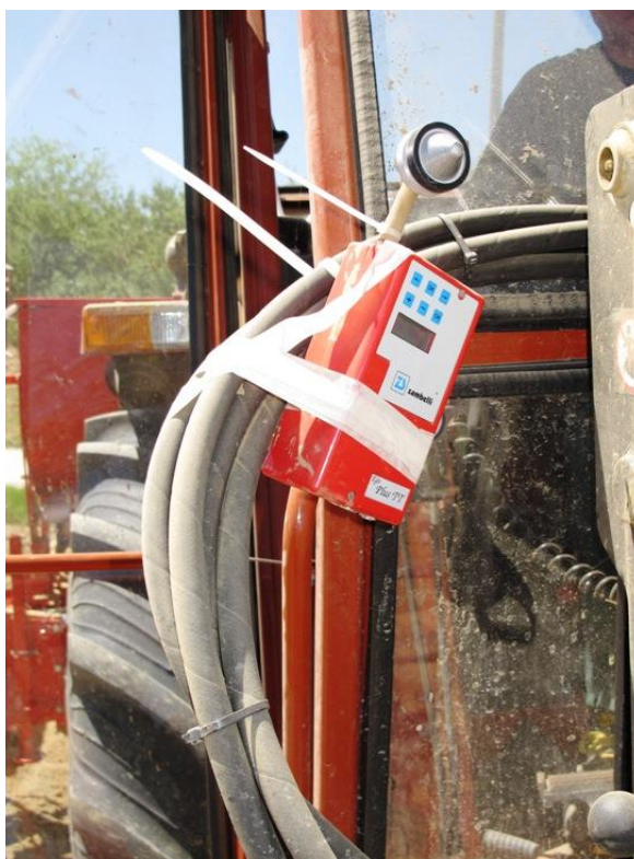
Foto 6. Un campionatore personale adattato al campionamento su trattore
