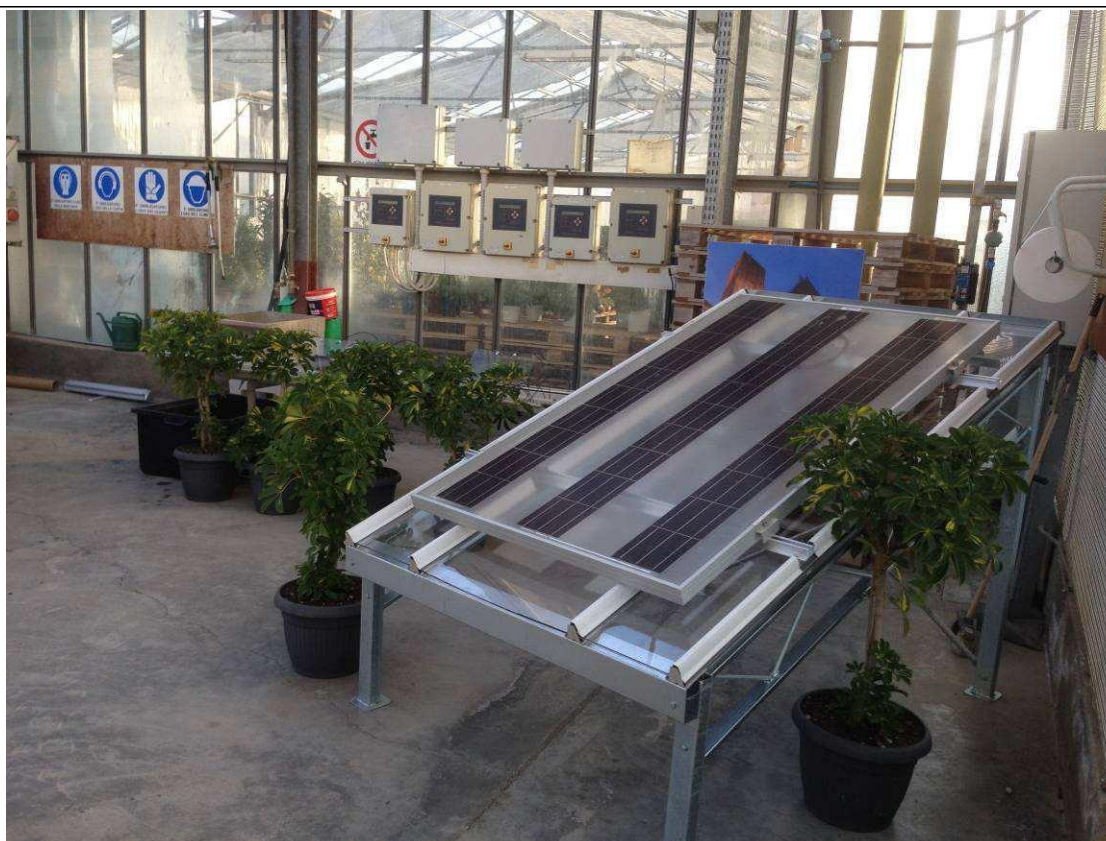
Fig. 20 – Modellino appositamente realizzato per rendere il sistema trasportabile (fiere, mostre, convegni, ...) e visibile in ogni sua parte anche da terra
