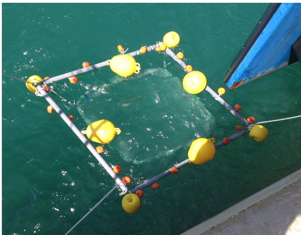
Figura 9: Prima prova funzionale (galleggiamento e apertura) di un modulo (10 metri)
