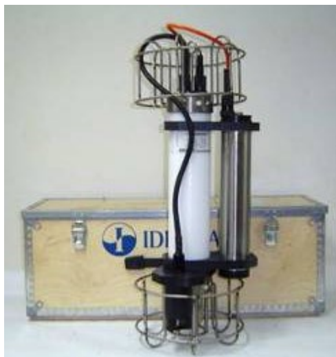
Figura 12 : Sonda multiparametrica Ocean Seven 316, Idronaut, CTD + Fluorimetro (sensore esterno), Ph, Ossigeno disciolto,
