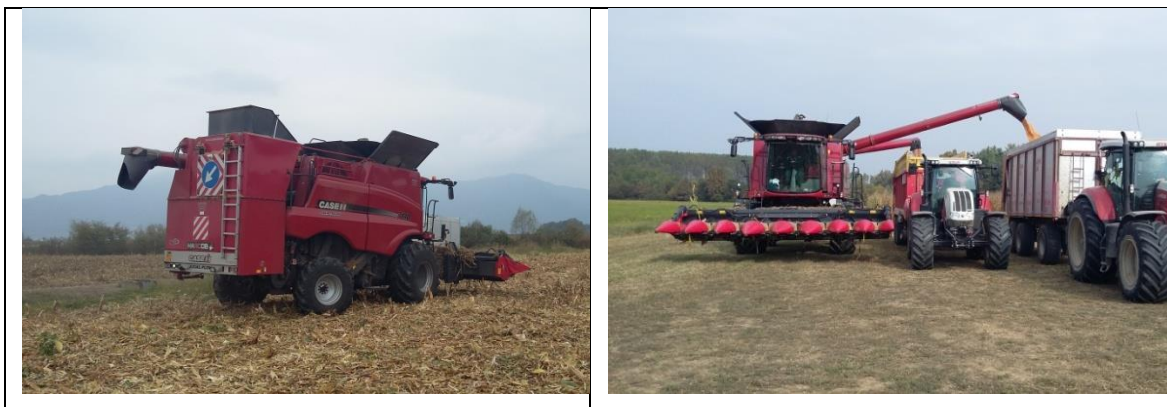
Figura 5 - Mietitrebbia equipaggiata con il sistema “Harcob” per il recupero dei tutoli
