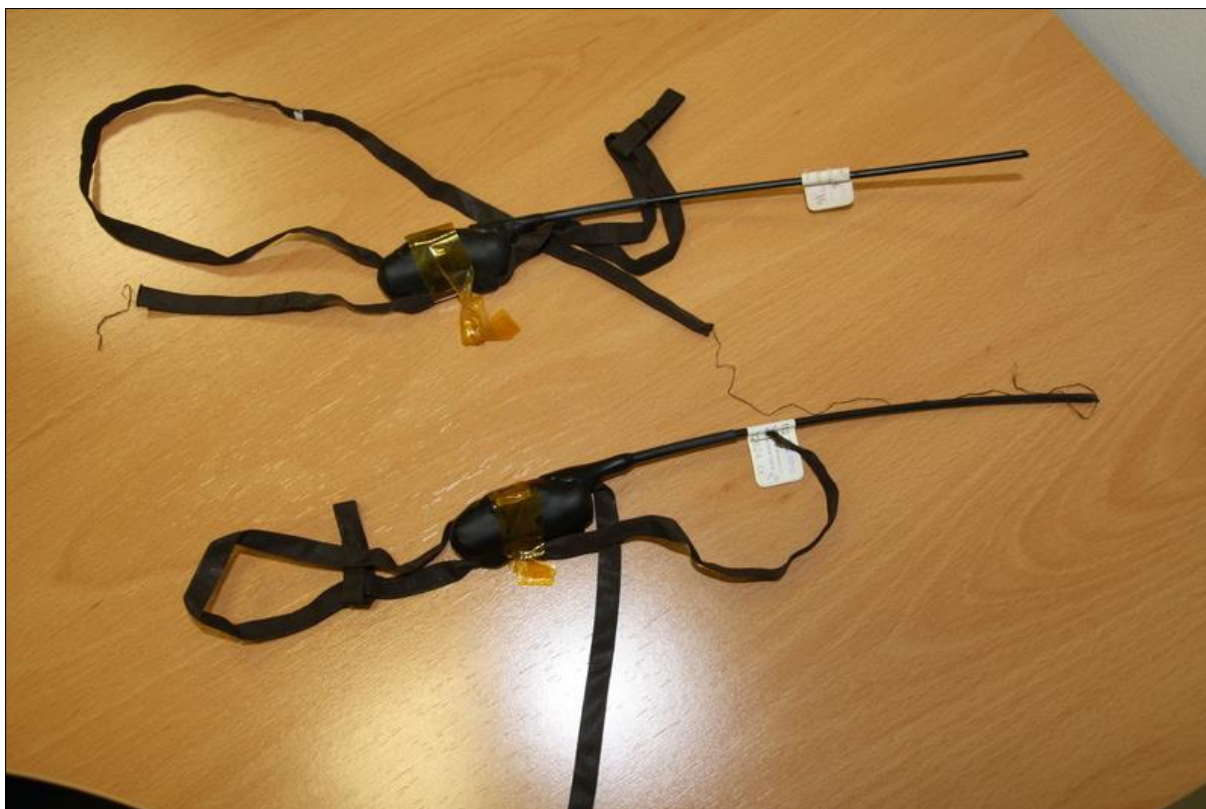
Fig. 4.5. Due degli emissori usati per l'attività di radio-tracking. Venivano forniti dal produttore privi del nastro in teflon, apposto successivamente. Tale nastro di fissare l'emissore sul dorso dell'animale,, l'antenna era posizionata direzione capo-coda in maniera da non ostacolare le normali attività compiute dagli animali. Le targhe visibili sull'antenna contenevano la frequenza emessa, che veniva annotata in un registro insieme a tutti i dati dell'animale acui era destinato: sesso, età, nido di nascita ed eventuale nido in cui era stato spostato. Prima di essere posizionato sull'animale doveva essere testato il suo funzionamento verificando che il ricevitore ricevesse il relativo segnale emesso. Foto A. Fasciolo
