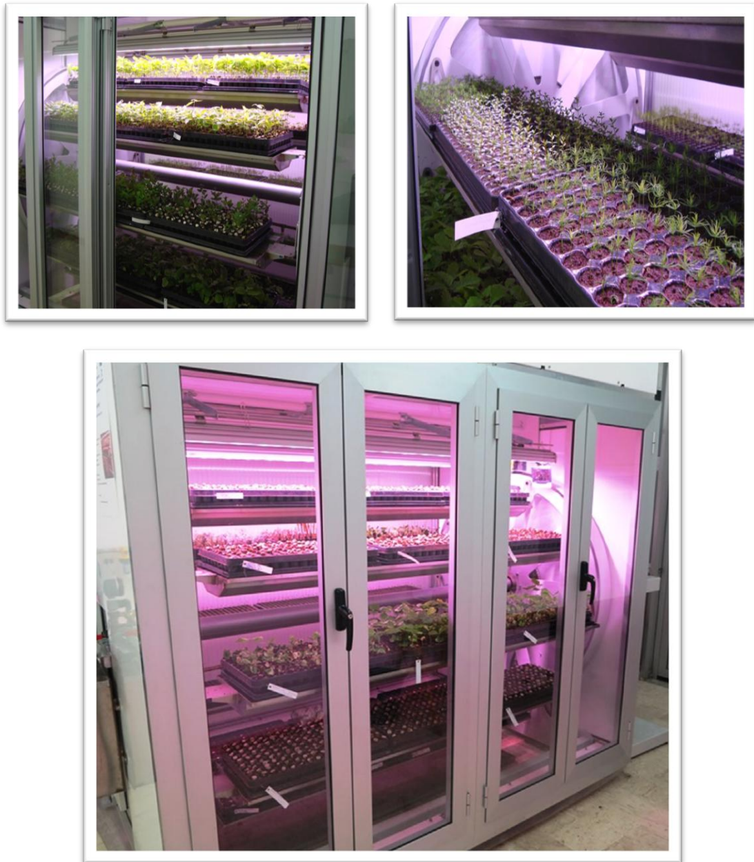
Figura 1.1 - Il Prototipo realizzato nell'ambito del progetto di ricerca Regen-Forest. È possibile notare i ripiani e i contenitori con le piante.
