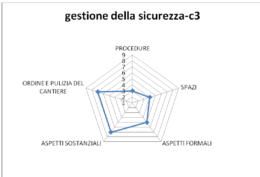
Grafico 4.15. Gestione della sicurezza (sezione 4 della check list) nel cantiere c3(1: totale difformità, 9: eccellenza).
