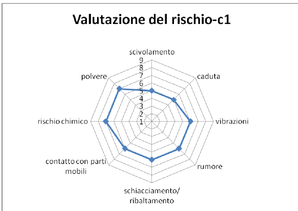
Grafico 4.10. Valutazione del rischio (sezione 3 della check list) nel cantiere c1(1: rischio massimo, 9: rischio trascurabile).
