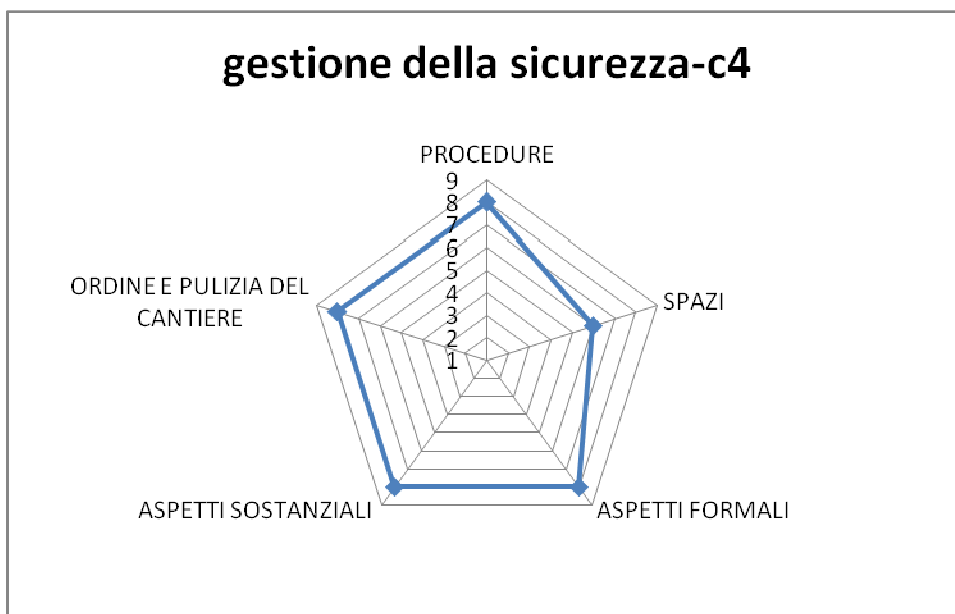
Grafico 4.17. Gestione della sicurezza (sezione 4 della check list) nel cantiere c4 (1: totale difformità, 9: eccellenza).
