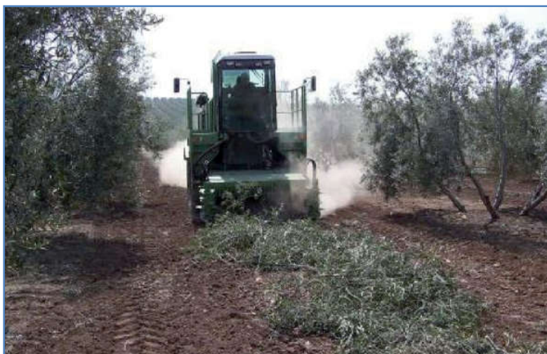
Figura 28: raccolta dei residui di potatura con macchina trincia caricatrice.
