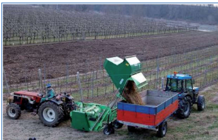
Figura 24: macchina trincia sarmenti con contenitore posterior ribaltabile.
