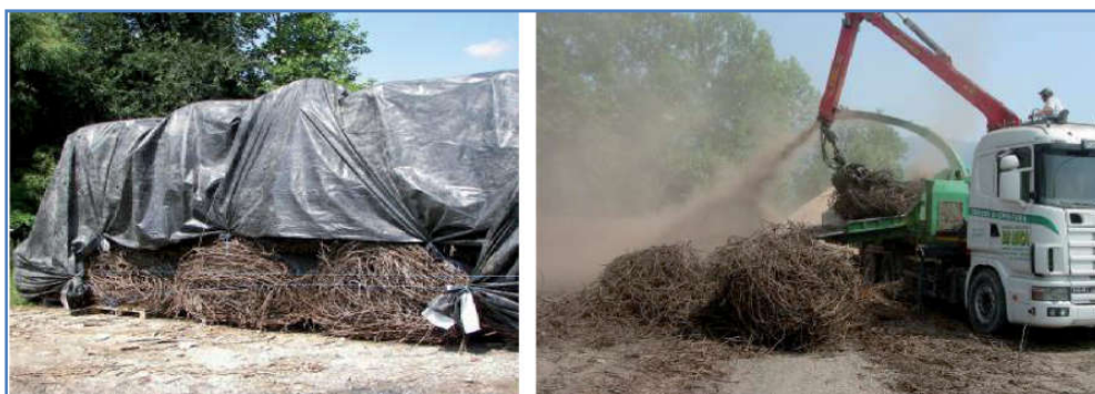
Figura 25: deposito di balle di sarmenti di vite in essiccazione; cippatura delle balle di sarmenti di vite.
