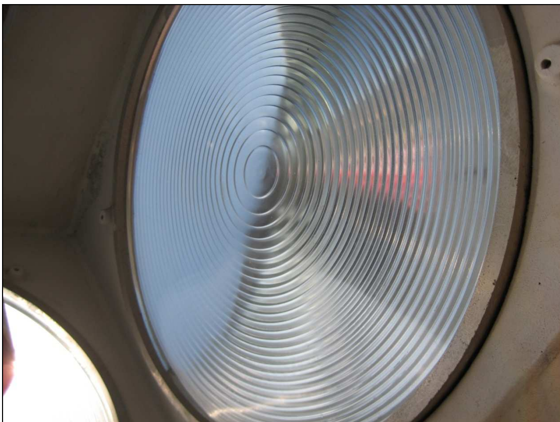
Figura 1.6 Concentratore con una lenti di Fresnel
