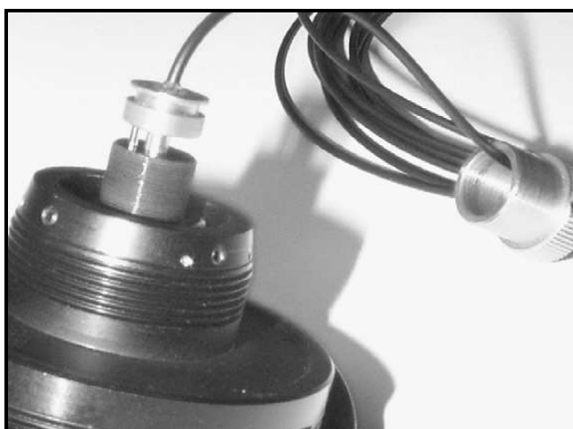
Figura 1.11 Sistema di fuocoheggiamento per l'accoppiamento delle fibre ottiche (INOA 2003)
