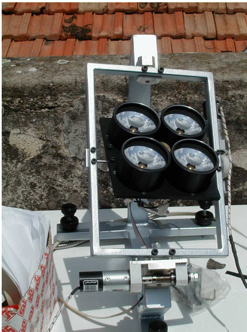
Figura 1.8 Dispositivo di illuminazione a fibre ottiche Inoa 2003
