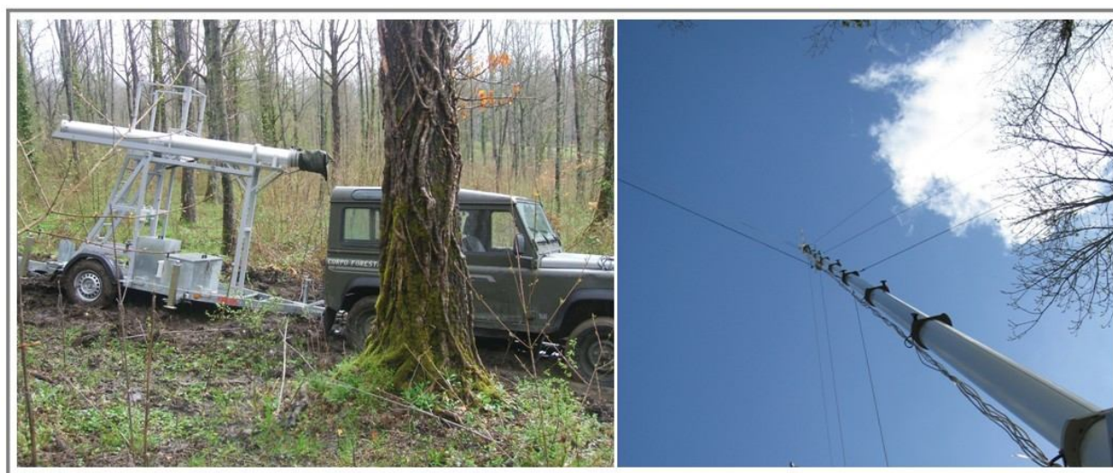
Figura 1: foto del sistema mobile EC durante il trasporto in bosco con il fuoristrada del Corpo Forestale dello Stato (a sinistra) e dopo l'installazione (a destra) a colonna aperta, da notare i tiranti e i passacavi descritti nel testo.
