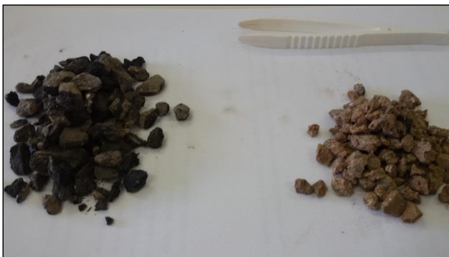
Figura 3.3 – Separazione manuale delle scorie nere dalla pasta di fondo in un campione di Ignimbrite C.
