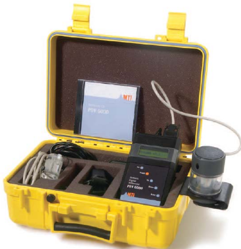
Figura 4.2: esempio di sistema portatile per la determinazione di As in campo (modello PDV6000-Plus, prodotto da “Cogent Environmental”).
