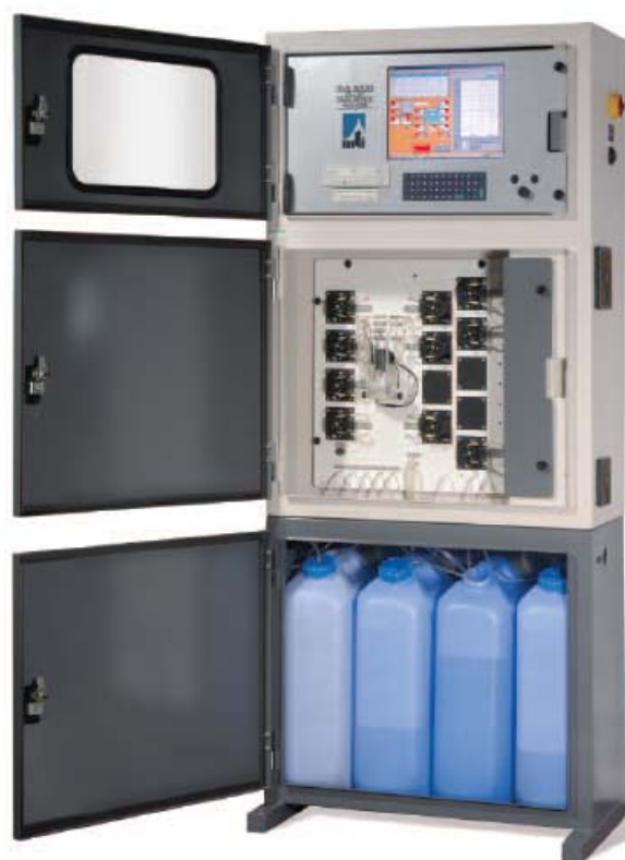
Figura 4.3: esempio di sistema di monitoraggio in linea per la determinazione di As in tempo reale (modello OVA5000, prodotto da “Cogent Environmental”).
