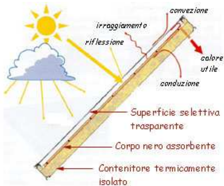
Figura 7. Schema di un collettore solare
