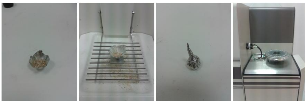
Figura 34: Fasi di preparazione del campione per le analisi di C, H e N.
