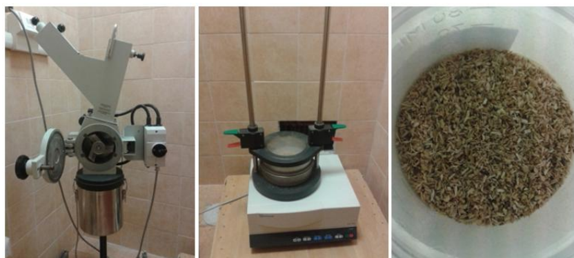
Figura 30: Fasi di trasformazione del campione in segatura.
