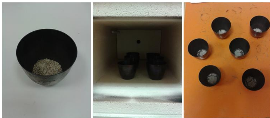
Figura 36: Crogioli contenenti campioni di biomassa e relative ceneri.
