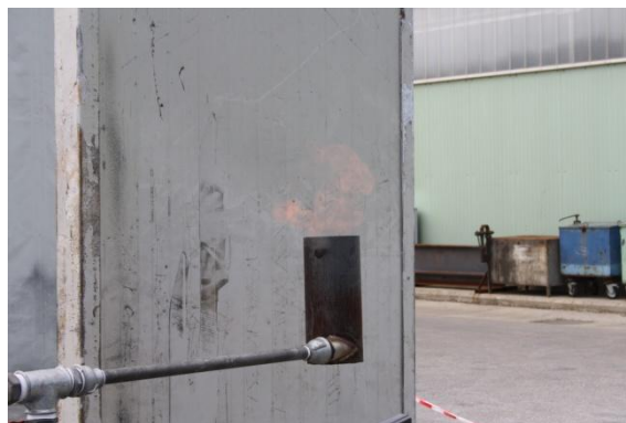
Figura 60: Combustione in torcia.
