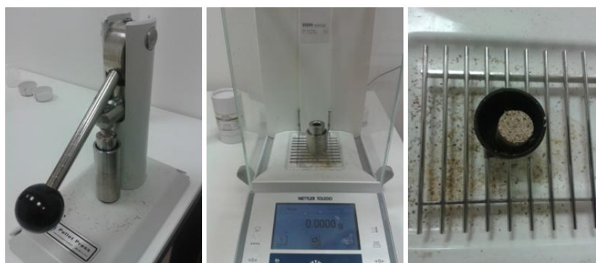
Figura 31: Fasi di realizzazione della pasticca di biomassa.
