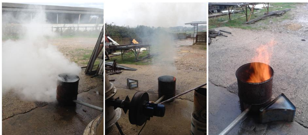
Figura 42: Fase di deumidificazione della biomassa e di produzione di syngas combustibile.
