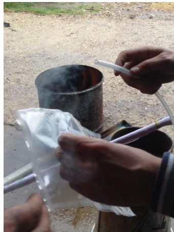
Figura 44: Fase di prelievo dei campioni di syngas.
