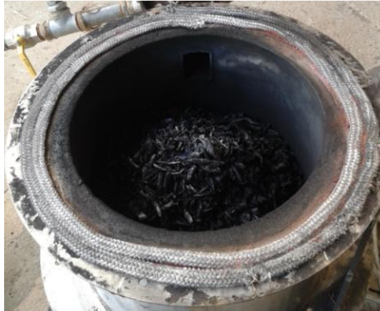
Figura 45: Char prodotto all'interno del reattore durante il processo di gassificazione.
