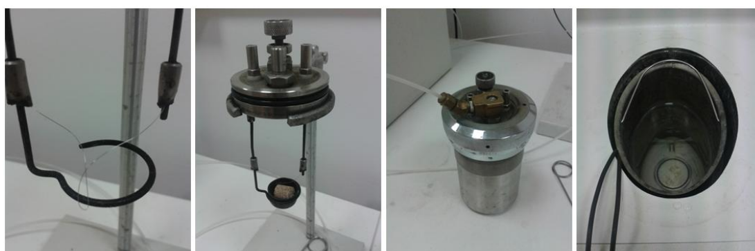
Figura 32: Fasi di preparazione della bomba calorimetrica.
