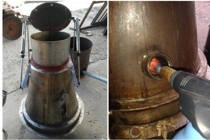
Figura 41: Apertura per il caricamento della biomassa e fase di accensione della biomassa.
