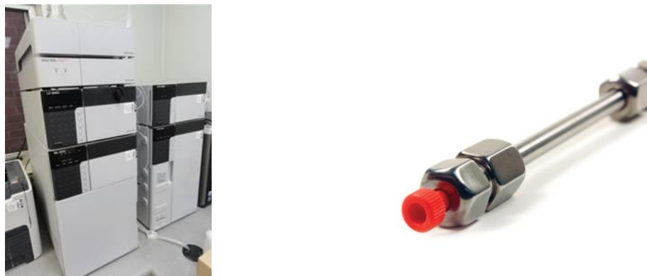
Figura 8: sx) strumento HPLC usato per le analisi; dx) colonna usata per la separazione cromatografica
