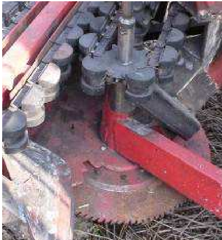
Foto 30 – Particolare del dispositivo di convogliamento. È possibile notare la posizione avanzata della catena gommata situata sul lato destro.
