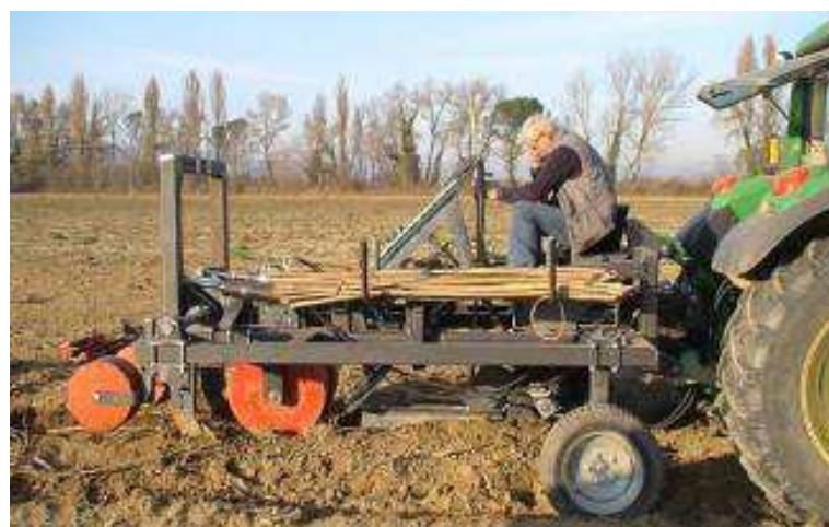
Foto 42 –Posizionamento dell’astone nell’apposito alloggiamento frontale.
