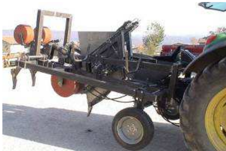
Foto 41 – Macchina in fase di trasporto. I dispositivi di lavoro sono in posizione retratta.
