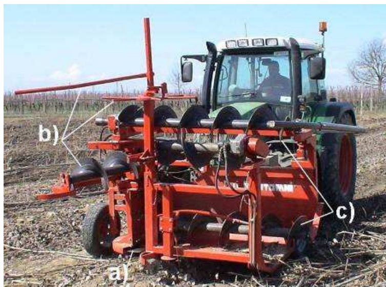
Foto 14 - Particolari del sistema di taglio (a), convogliamento (b) e trasporto (c).
