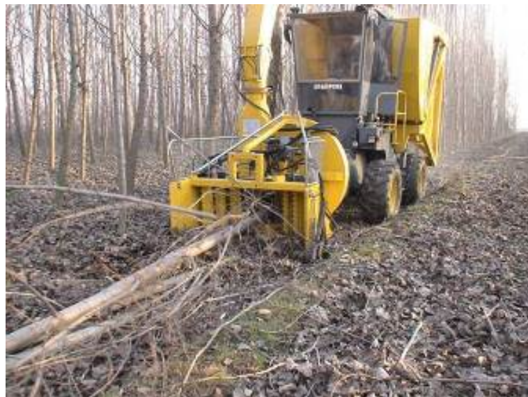
Foto 51 – Cantiere di raccolta e cippatura con scarico nel cassone posteriore.
