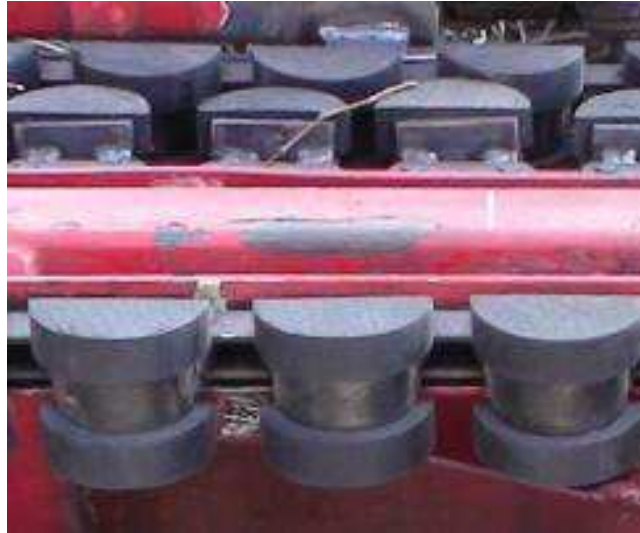
Foto 32 – Particolare delle gomme montate sulle catene di trasporto.
