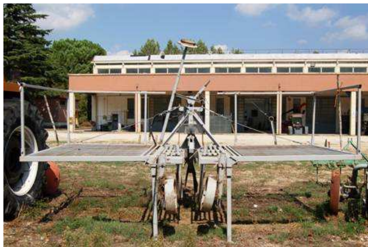
Foto 19 – Trapiantatrice di astoni Alasia munita di assolcatore e dischi chiudi solco.
