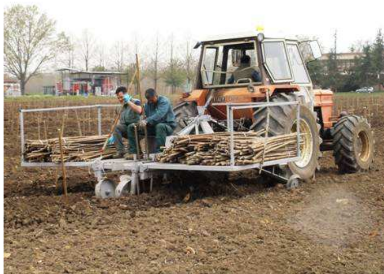
Foto 20 – Trapiantatrice di astoni in fase di impianto.
