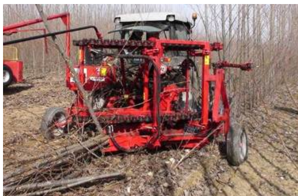
Foto 39 – Abbattitrice andanatrice in raccolta di pioppo di due anni di radice e due anni di fusto.
