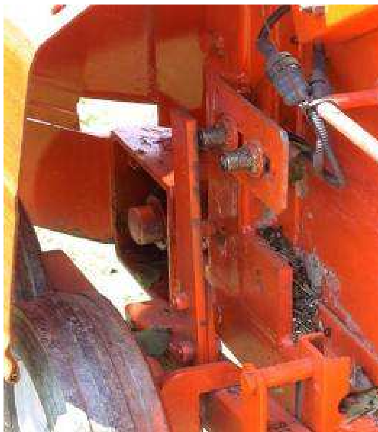
Foto 18 – Particolari del dispositivo di autolivellamento.
