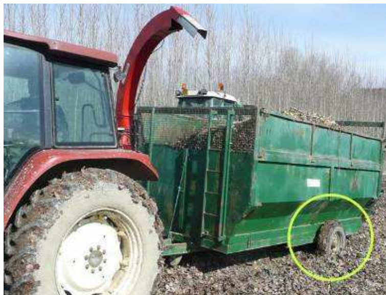
Foto 2 – Carreggiata prodotta dal transito di un rimorchio con pneumatici a sezione ridotta.
