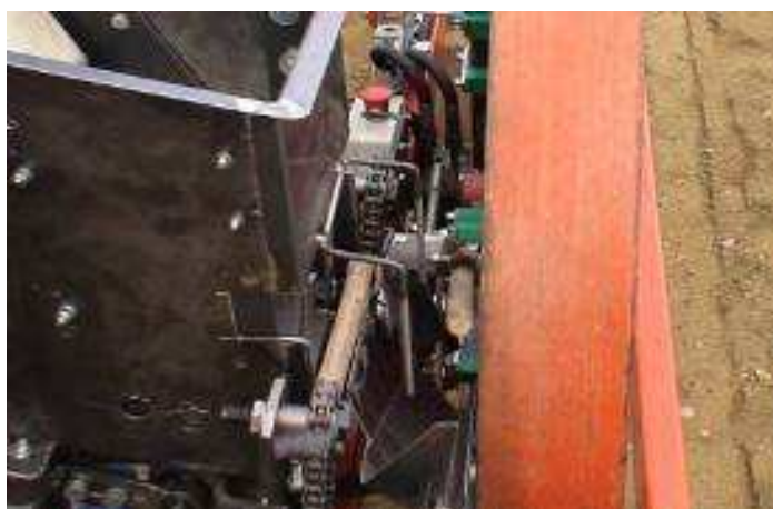
Foto 35 – Particolare del sistema di alimentazione e di inserimento delle talee.
