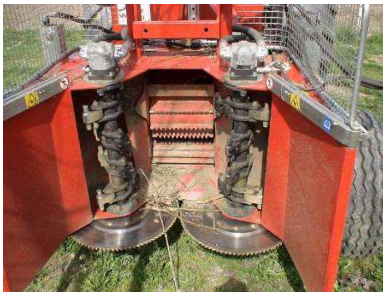
Foto 3 – Testata Spapperi RT per la raccolta del pioppo biennale in piedi.
