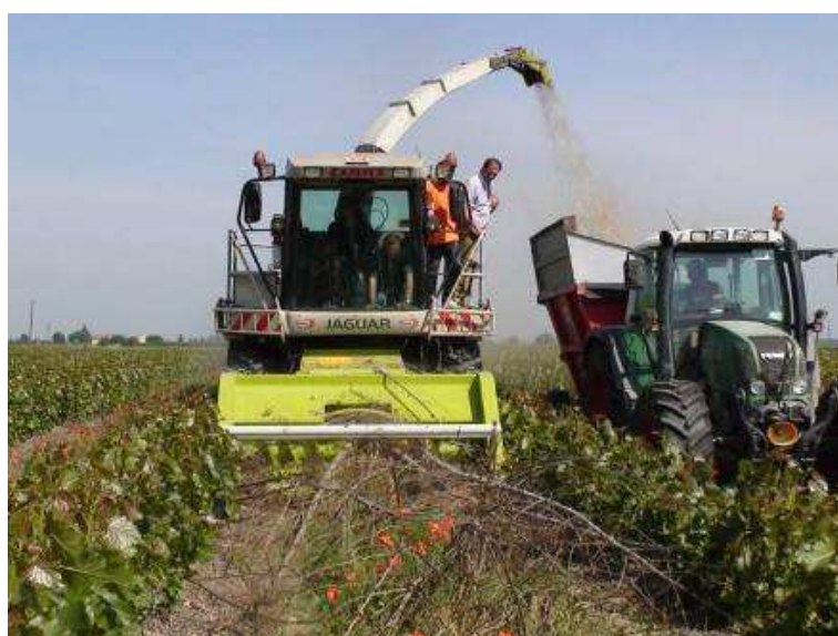
Foto 26 – Claas Jaguar con testata pick up in raccolta di pioppo biennale andanato.
