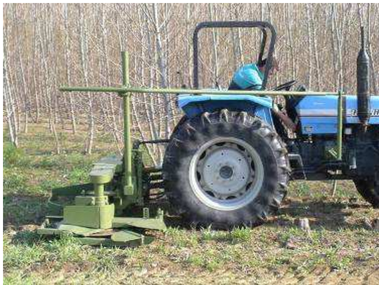
Foto 7 - Abbattitrice ZPZ. Sono visibili il dispositivo di taglio e il profilato in metallo per agevolare la caduta delle piante.
