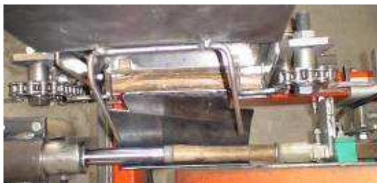
Foto 37 – Fase di inserimento della talea nella pinzetta.
