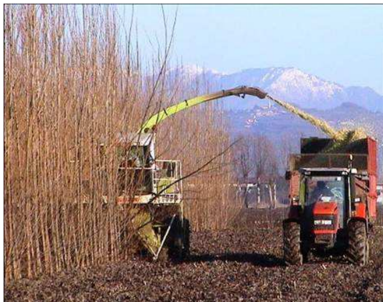
Foto 6 – Claas Jaguar con testata GBE-1 in raccolta di pioppo biennale in piedi.
