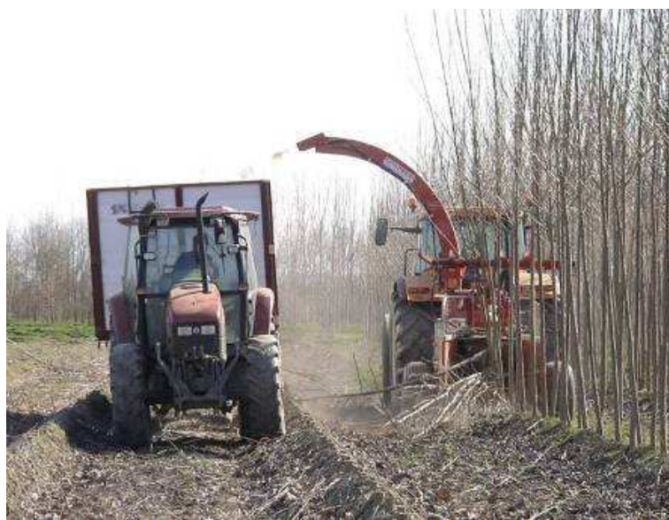
Foto 4 – Falcitrinciacaricatrice Spapperi mod. RT in raccolta di pioppo.
