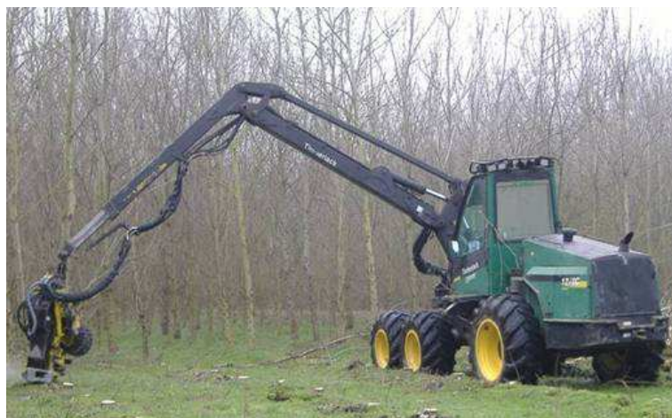
Foto 21 - Testata Timberjack 762 C su motrice forestale 1270 B.
