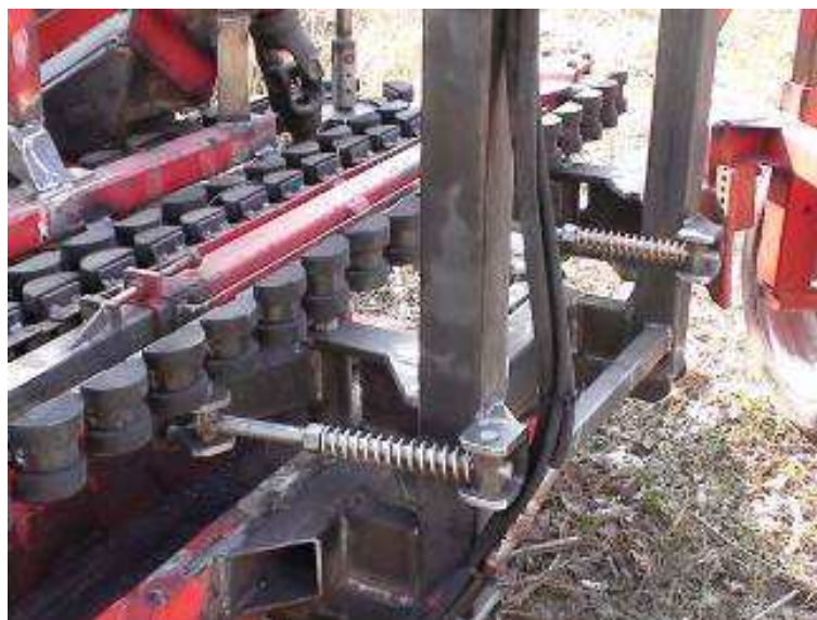
Foto 31 – Dispositivo di trasporto inferiore. Sono visibili i braccetti snodati con molle ad elevata resistenza a compressione.
