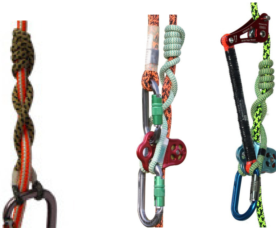
Figura 23 – Tre configurazioni di nodo valdostano, da sinistra: configurazione semplice, sistema Hitch Climber con carrucola per facilitare il tiro della fune, con Rope Wrench per utilizzo in SRT
