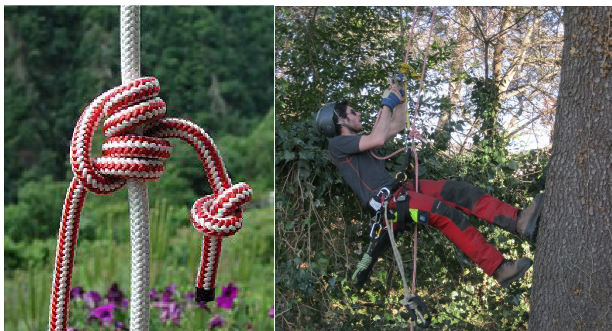
Figura 22. – Nodo bellunese e operatore che risale con nodo bellunese su DdRT.
