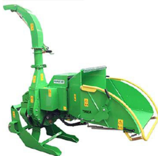
Figura 32 – Cippatrice a disco modello Peruzzo TREX, utilizzata per testare il freno a disco di emergenza
