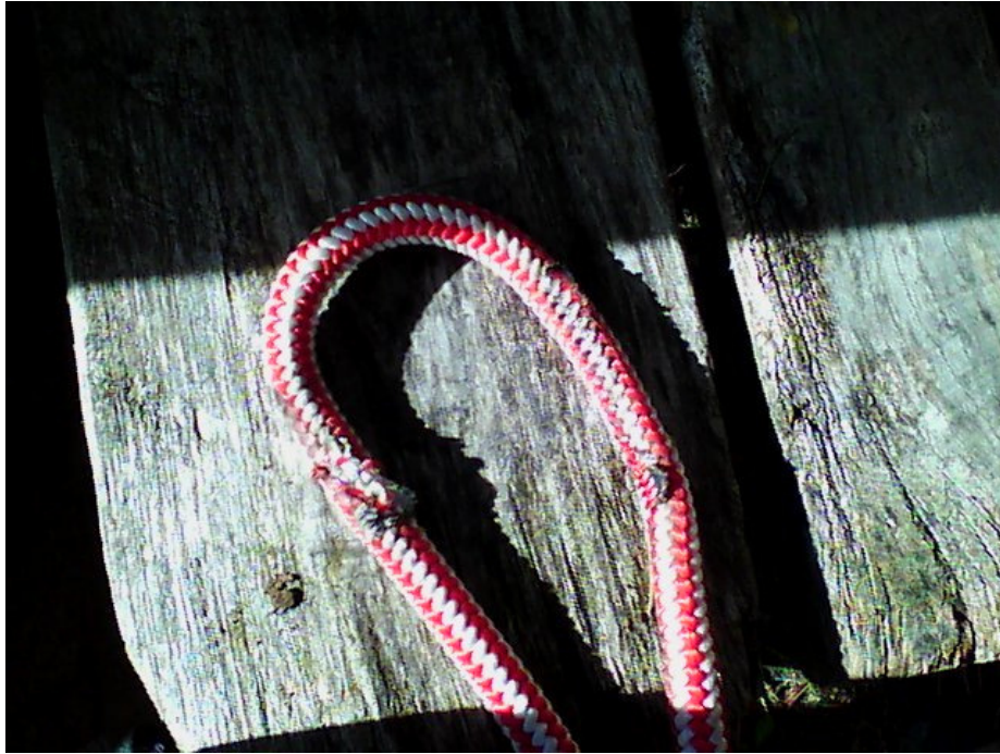
Figura 29 – Fusione della calza del cordino bellunese
