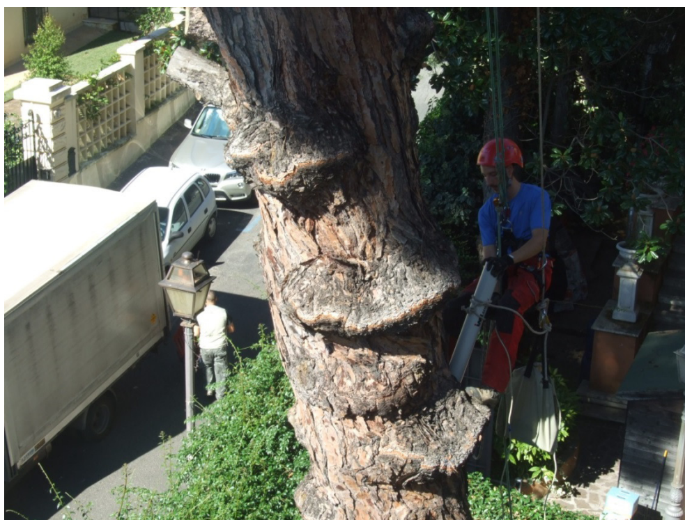
Figura 1- Arboricoltore su fune impegnato nella misurazione della resistenza del legno tramite dendrodensimetro Resi F400 S.
