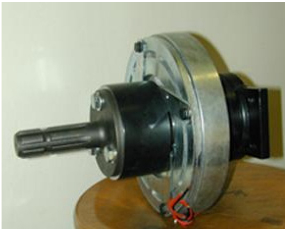
Figura 33 – Frizione elettromagnetica per il disaccoppiamento
