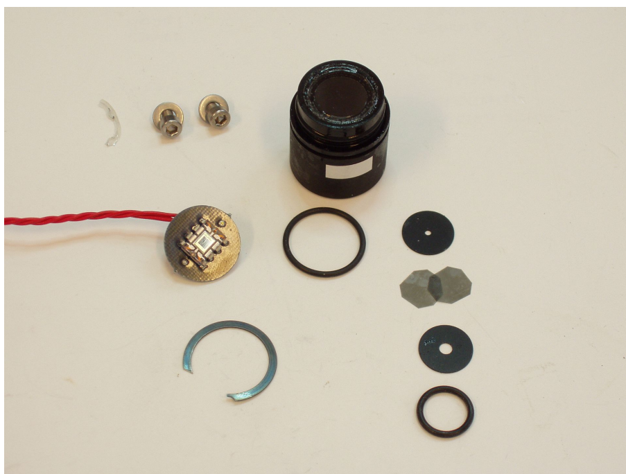
Fig. 5.7. Elementi del sensore di torbidità T-FLAP
