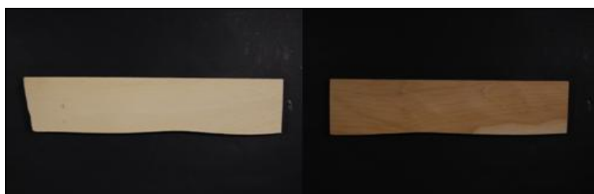
Figura 19. Tavolette di Fagus sylvatica L. per le misure del colore prima dell'esposizione alla radiazione luminosa. A sinistra legno normale e a destra legno con cuore rosso.
