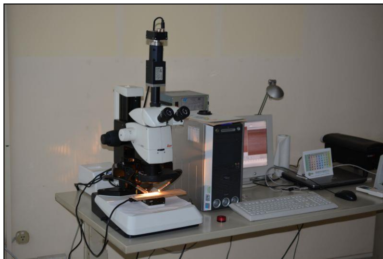
Figura 23. Strumento ImSpector V10E, montato su un microscopio Leica M205C.
