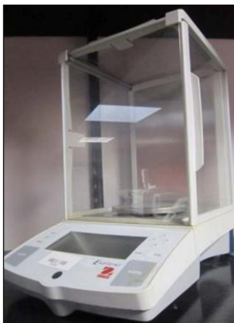
Figura 16. Bilancia analitica modello Explorer Ohaus.
