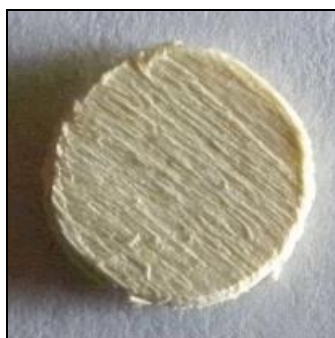
Figura 18. Campione di Populus L. per gli spettri FT-IT prima dell'esposizione alla radiazione luminosa.
