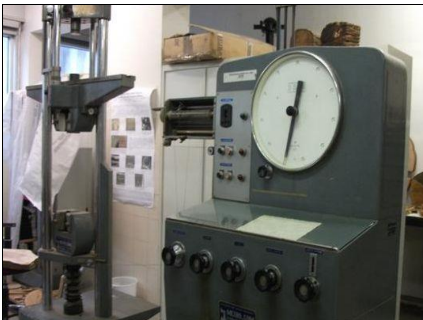
Figura 17. Macchina prova materiali METRO-COM Engineering s.p.a.
