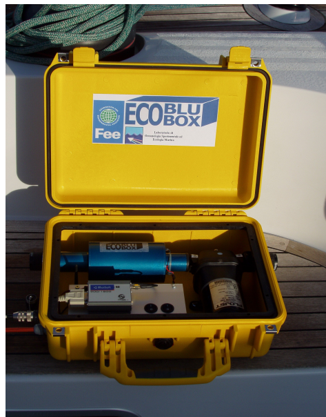
Fig 24: Modulo EcoBluBox : A destra in nero pompa per aspirare l'acqua; in alto in blu prototipo EcoBluBox contenente i sensori; tubi per circuito in entrata e uscita dell'acqua, da attaccare a una o due prese a mare.
