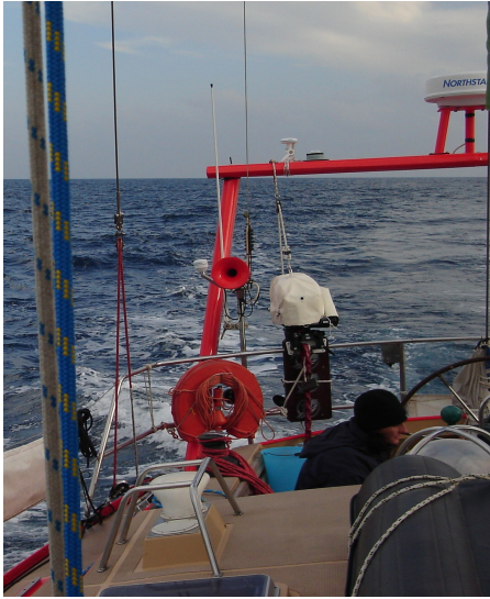
Fig 16: Sensore di temperatura dell'aria e piranometro in alto a sinistra su toolbar
