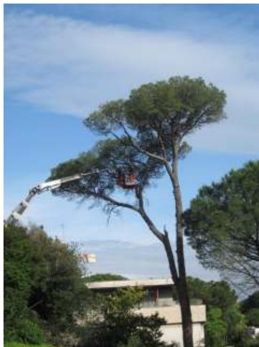
Foto 32 – Piattaforma aerea da 34 m al lavoro su piante con altezza superiore ai 15m
