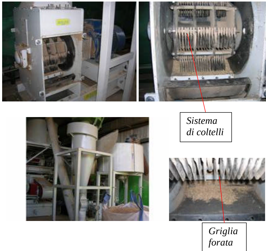
Figura 19: In alto a sinistra il rotore interno del mulino, a destra i sistemi di coltelli, sotto a destra il dettaglio della griglia forata e a sinistra il ciclone ad aria forzata adibito allo scarico.
