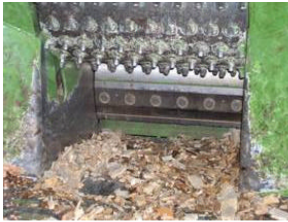
Figura 7: tamburo rotante con dettaglio dei bulloni di fissaggio del coltello
