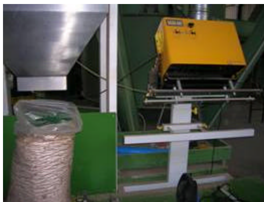
Figura 14: a sinistra aspetto del cippato intermedio sfuso, a destra macchina insaccatrice, sotto tramoggia di scarico e termosaldatrice
