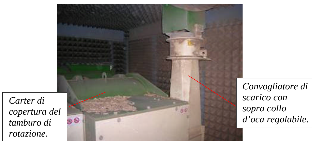
Figura 9: parte posteriore della macchina, con sistema di espulsione del materiale
