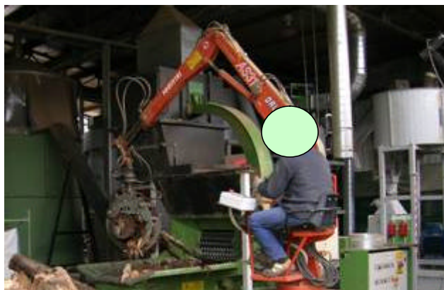
Figura 10: dettaglio della modalità di caricamento del cippatore
