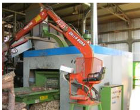
Figura 5: legname di pino scaricato nello spazio di alimentazione della cippatrice e particolare del caricatore idraulico fisso Modello Dalla Bona AS 31 per l'alimentazione della macchina
