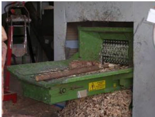
Figura 6: particolare del sistema di alimentazione della macchina cippatrice
