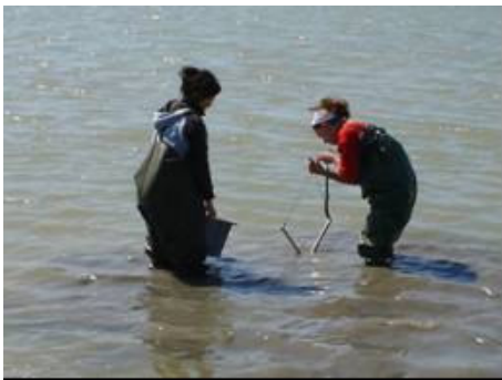
Fig 8 e 9 - Fasi del campionamento del macrozoobenthos: prelievo del campione e setacciatura.
