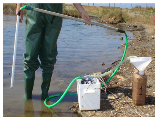
Fig. 11 e 12 - Fase del campionamento del fitoplancton e immagine della pompa aspirante.
