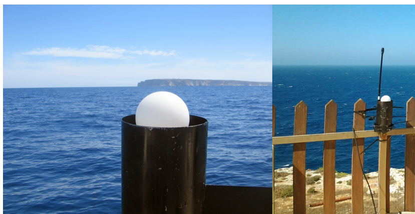
Figura 51- Sensore Li-193 installato sull'apposito supporto, durante le operazioni di misura. A destra, il sensore installato presso la stazione di terra, in parallelo allo spettrometro METCON DAS per il flusso attinico tra 280 e 700 nm, già presente presso la Stazione per le Osservazioni Climatiche di Lampedusa.
