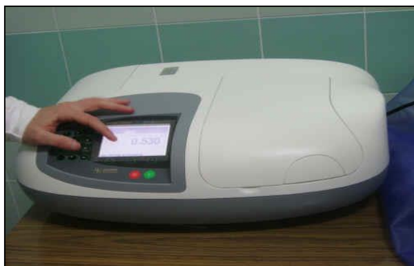
Figura 17. Spettrofotometro utilizzato per la determinazione del contenuto di nitrati nel suolo.
