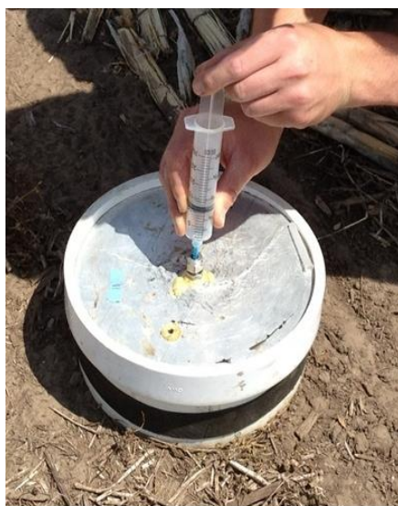
Figura 19. Rilievo del protossido di azoto con il metodo delle camere mobili
