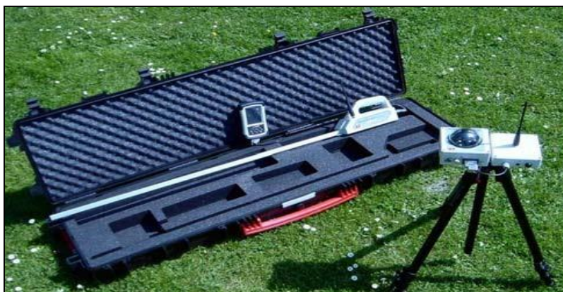
Figura 11. Strumento Sunscan utilizzato per i rilievi della radiazione PAR assorbita dalla vegetazione.
