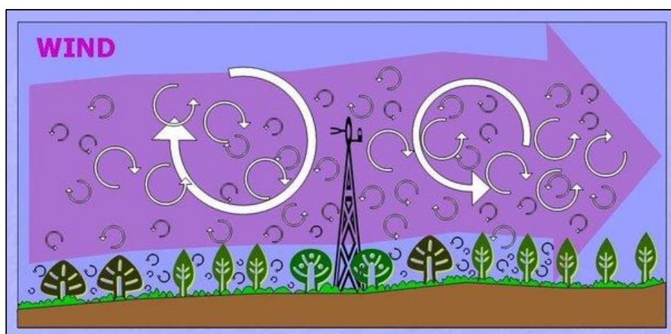
Figura 7. Moti dei vortici turbolenti, che si registrano tramite la tecnica della eddy covariance.
