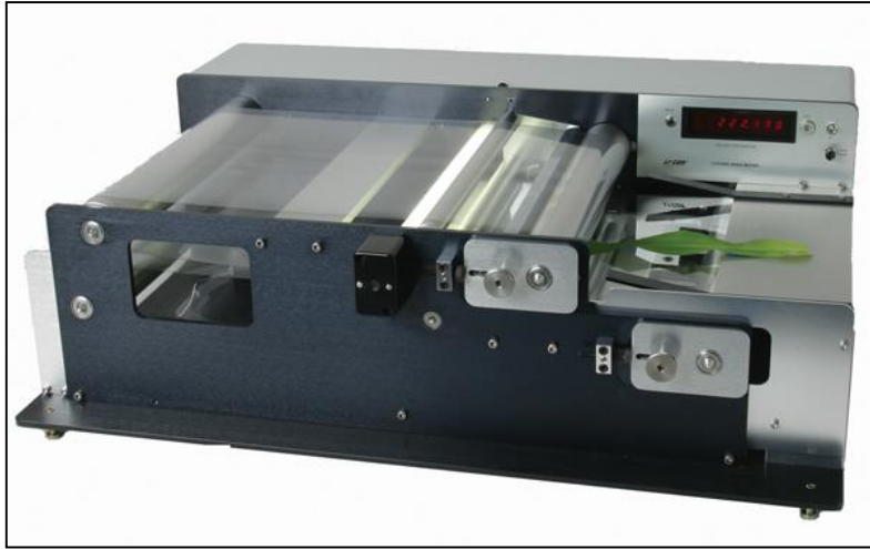
Figura 10. Area meter Li-3100, utilizzato per il calcolo diretto del LAI
