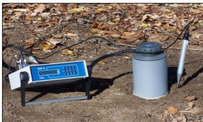
Figura 18. Strumentazione PP-System per la registrazione del flusso di carbonio nel terreno.
