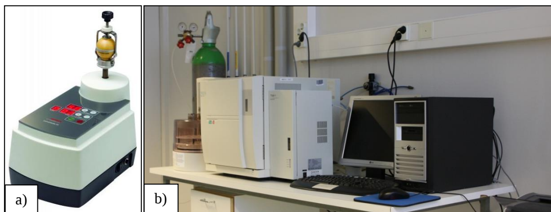
Figura 13. a) Polverizzatore Fritsch b) Analizzatore elementare FlashEA1112.
