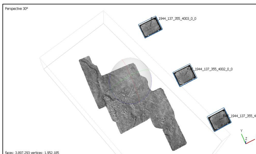
Figura 50 Orientamento simultaneo delle immagini nello stesso sistema per la produzione di un Digital Surface Model (DSM). Immagine autoprodotta in Metashape®
