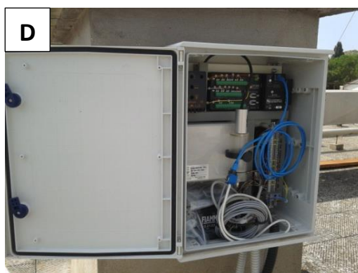
Foto 2. A: Modulo di verde semi-intensivo; B: pirometro per la misura della temperatura sopra la vegetazione del modulo di verde estensivo; C: sensori per la misura della temperatura e umidità del substrato; D :datalogger per la raccolta dei dati.; E: sensore per la misura della temperatura dell'aria e pannello solare per l'alimentazione elettrica del sistema
