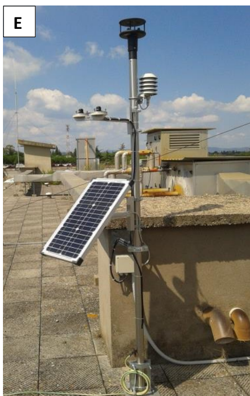
Foto 2. A: Modulo di verde semi-intensivo; B: pirometro per la misura della temperatura sopra la vegetazione del modulo di verde estensivo; C: sensori per la misura della temperatura e umidità del substrato; D :datalogger per la raccolta dei dati.; E: sensore per la misura della temperatura dell'aria e pannello solare per l'alimentazione elettrica del sistema
