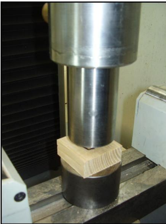
Figura 5.2: particolare del provino sottoposto alla prova di resistenza a penetrazione.
