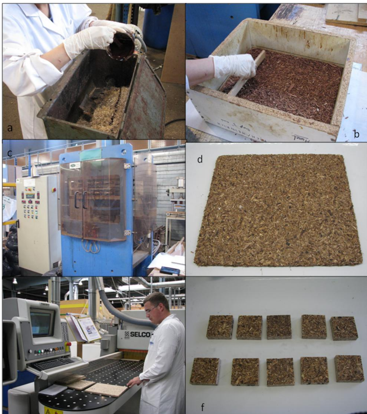
Fig. 5 Diverse fasi di preparazione dei pannelli: a) miscelazione meccanica del preparato legno-resina, b) disposizione della miscela legno –resina in stampo quadrato, c) pressatura, d) tavoletta pressata, e) refilatura del pannello e taglio dei campioni per realizzare provini da testare, e) provini tagliati pronti per i test fisico-meccanici.
