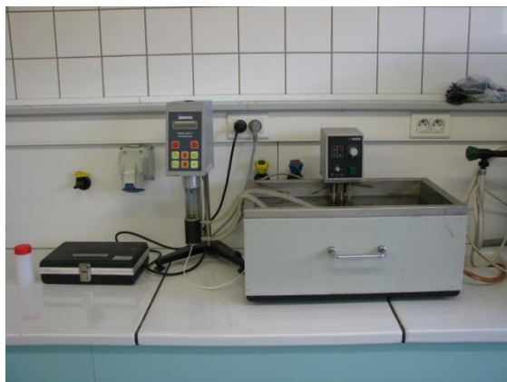
Fig. 3 La macchina Brookfield Mod.DV.+Visometer per il calcolo della viscosità
