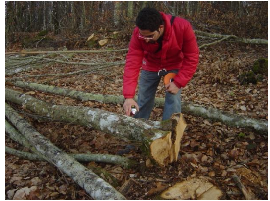
Fig. 3.2 – Fasi del campionamento e della marcatura dei campioni del materiale classificazione dendrometria e prima valutazione visiva dei difetti degli alberi
