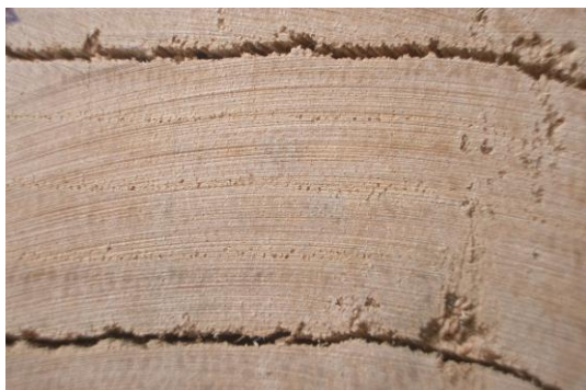
Fig. 4.5: fratture dell'anello poroso
