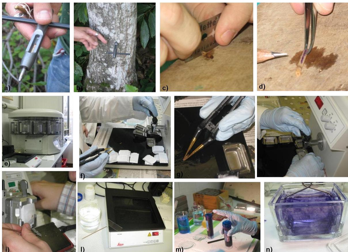
Figura 7.3 Fasi della raccolta e della lavorazione dei campioni. a) il Trephor; b) campionamento con lo strumento inserito nel tronco. Girando le braccia si estrae lentamente evitando un taglio brusco dei tessuti nella pianta; c) la carotina viene ridotta di dimensioni; d) si segna la sezione trasversale; e) il Processatore di tessuti Leica TP 1020-1; f-h) inclusione delle carotine in vassoi con paraffina. I campioni vengono maneggiati con pinze elettriche e la paraffina viene mantenuta a 60°C dall'erogatore elettrico Leica EG 1120 ; i) il taglio al microtomo elettronico a rotazione Leica RM 2245; l)cassetta d'acqua a 40°C pronta per il fishing; m,n) colorazione dei vetrini e lavaggi in etanolo e bioclear.
