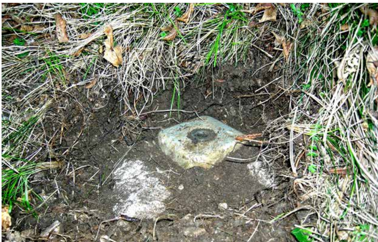
Figura 2.1. Picchetto permanente del punto C, interrato alcuni centimetri sotto il livello del terreno
