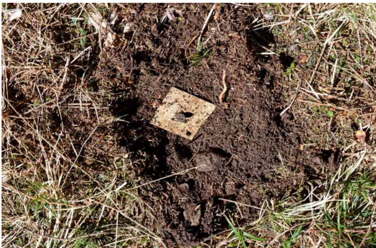
Figura 2.3. Picchetto “leggero” del punto F, interrato alcuni centimetri sotto il livello del terreno
