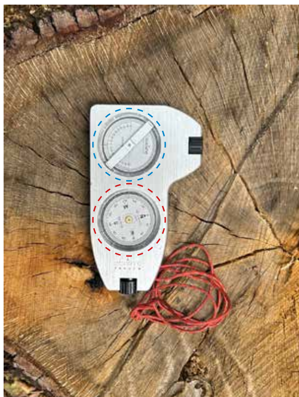
Figura A1.13. SUUNTO Tandem per la misura dell'azimut e dell'inclinazione; nel cerchio blu il mirino per la lettura del clisimetro tenendo lo strumento verticale, nel cerchio rosso il mirino della bussola, tenendo lo strumento orizzontale
