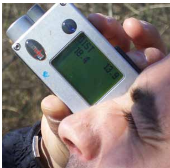
Figura A1.5. Vertex Haglöf: schermo dello strumento durante il suo utilizzo per una misura dell'altezza di un albero
