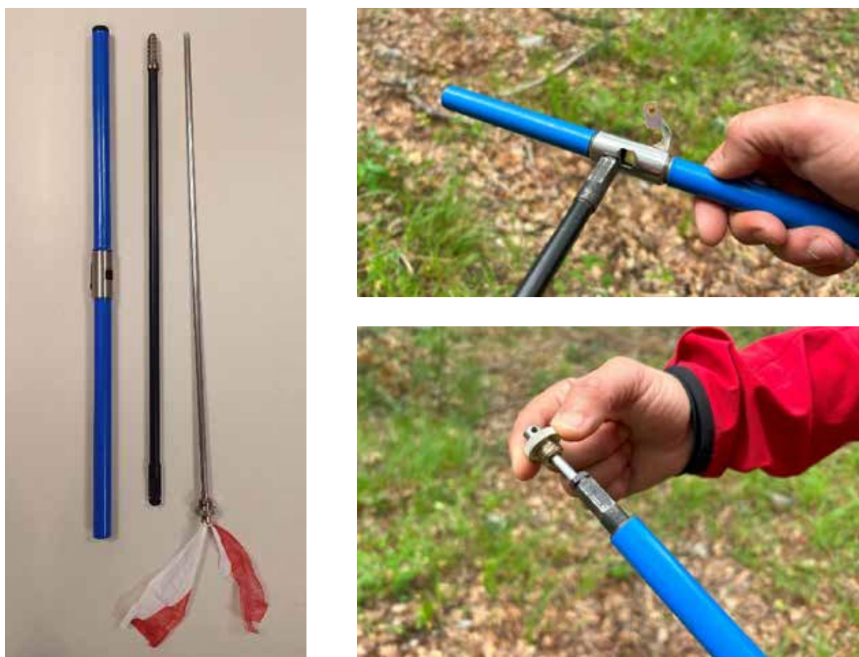
Figura A1.14. A sinistra: componenti del succhiello di Pressler (manico, trapano ed estrattore, su cui si consiglia di inserire un nastro colorato per una rapida individuazione se si dovesse poggiare a terra o in prossimità dell'albero da campionare). A destra: estrazione (in alto) e inserimento (in basso) del trapano
