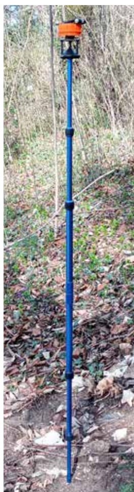
Figura A1.6 (a sinistra). Transponder , adattatore per misure a 360° (in nero) e Vertex Haglöf montati su palina
