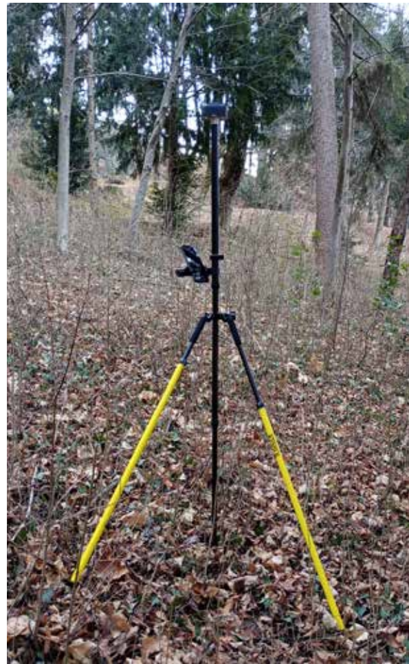
Figura 2.4. Il ricevitore GNSS Solutop MS2 in stazione su palina e bipiede, con smartphone per la gestione del rilievo
