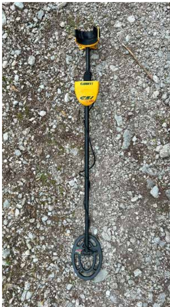
Figura A1.16. Un esempio di metal detector per la ricerca dei picchetti interrati
