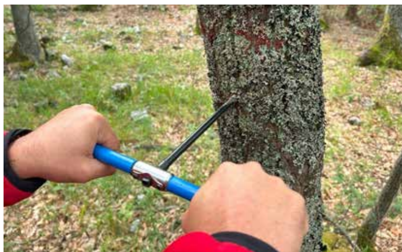
Figura A1.15. Avvitamento della trivella nel fusto e successiva estrazione della carotina
