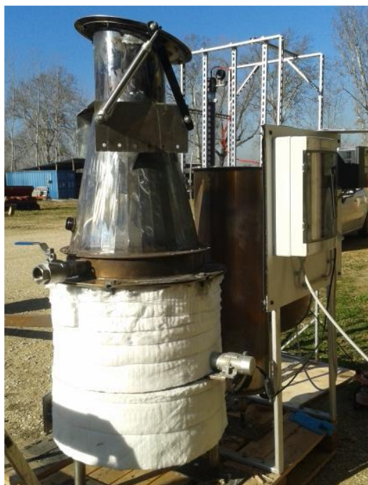
Figura 7. Rappresentazione schematica del prototipo di pirogassificatore impiegato per la produzione di syngas
