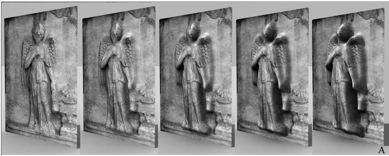
Figura 34 - Displacement mapping utilizzata per la modellazione con valori di deformazione differenti (da Limoncelli 2012).
