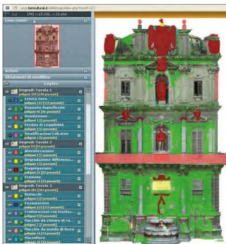
Figura 64 - Esempio di mappatura dei degradi, della facciata de I Quattro Canti a Palermo, tramite il SICaR (da Fabiani et al. 2016).
