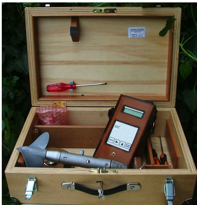
Foto 6.2 – Mulinello idrometrico S.I.A.P. ME-4001 e contatore CE-6015 utilizzati per le misure di portata.
