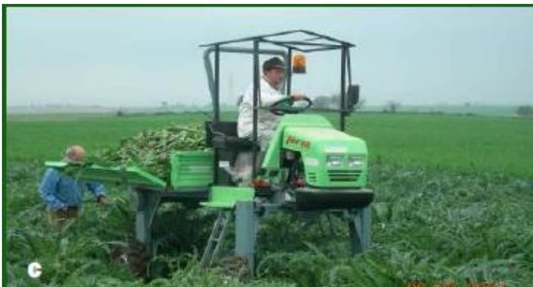
Foto 10: motocarro 4 ruote motrici montate su trampoli (fonte foto Cedrola et al. , 2009)
