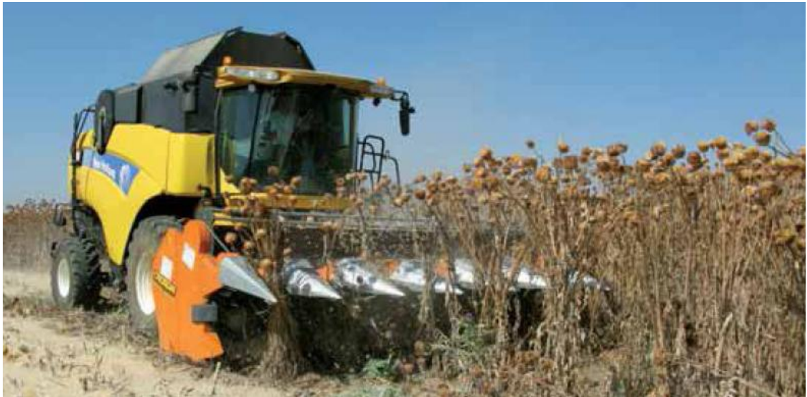
Foto 13 - mietitrebbiatrice munita di testata da cardo (Foto archivio Cra-Ing)
