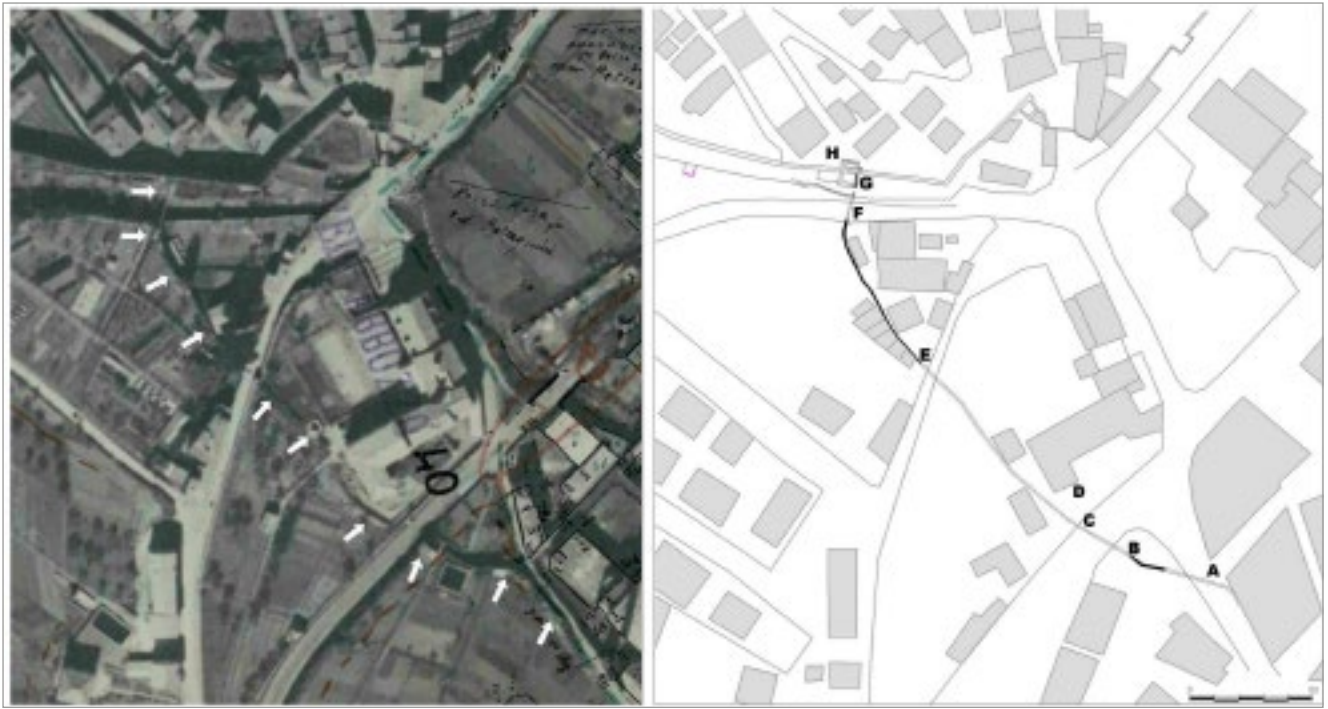
fig. 4 – A sinistra, l'area delle Pietrare in una immagine aerea del 1940 (Archivio di Stato di Viterbo, Metodo Nistri ), con le tracce relative all'acquedotto. A destra, planimetria delle evidenze.
