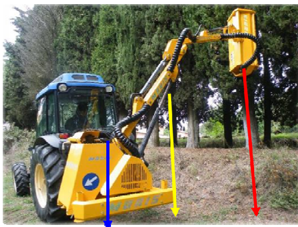
Figura 71 – causa ribaltamento, valutazione attrezzatura in estensione
