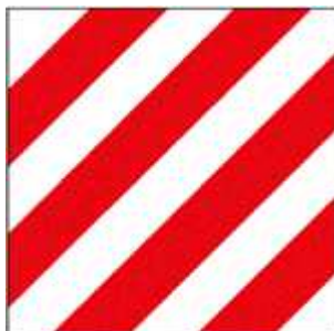
Figura 88 – pannello di segnalazione per macchine eccedenti le dimensioni previste
