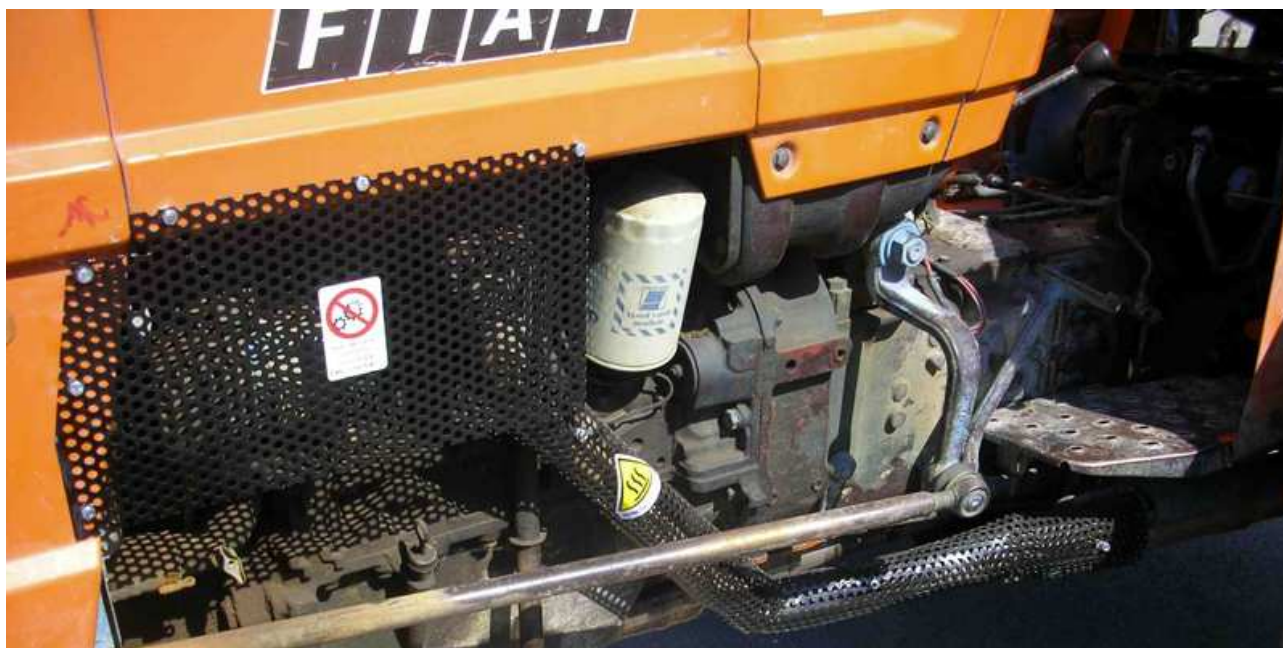
Figura 135. Adeguamento parti calde
