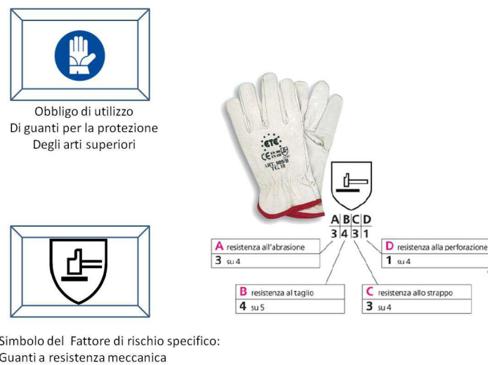
Figura 161. Elementi per la scelta di guanti a resistenza meccanica EN388
