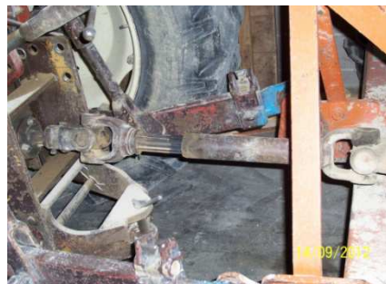
Figura 139. Assenza totale di protezione
