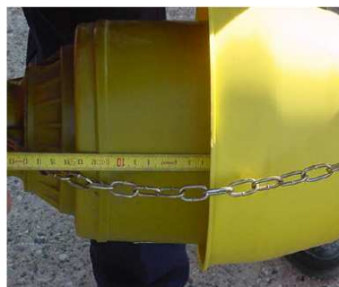
Figura 137. Valore di riferimento per la protezione (assenza di luce tra protezione ed albero)
