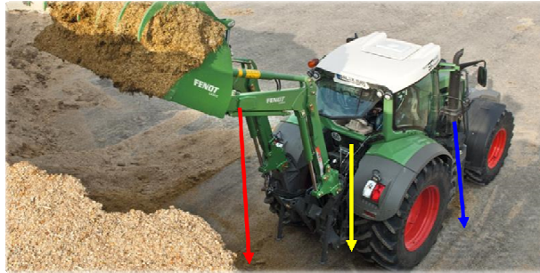
Figura 69 – causa di ribaltamento, valutazione attrezzature tipo caricatore
