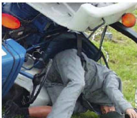
Figura 48 - Operatore all'interno del volume di sicurezza della macchina dopo ribaltamento fonte: http://nasdonline.org/document/113/d001656/rollover-protection-for-farm-tractor-operators.html
