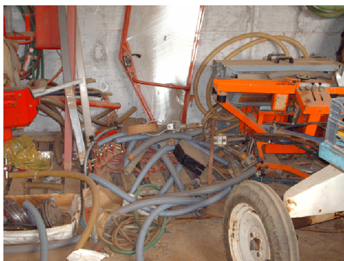
Figura 86 - condizioni di lavoro non conformi alla normativa, assenza di spazio e presenza di materiale e rifiuti nelle zone di lavoro
