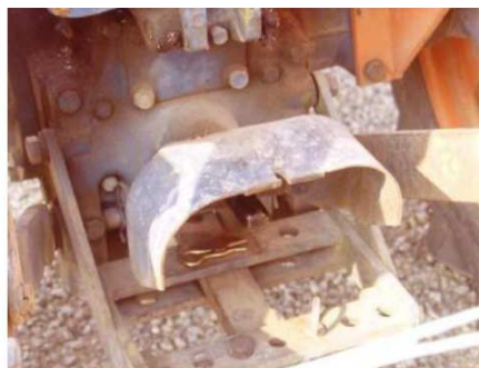
Fig. 6 - presa di forza protetta
