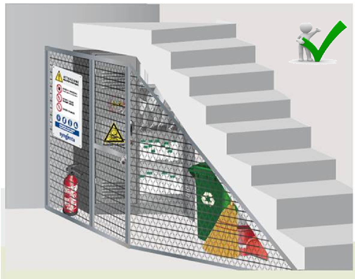
Figura 123. Esempio di collocazione corretta dei pittogrammi e segnaletica all'interno di un deposito di fitofarmaci
