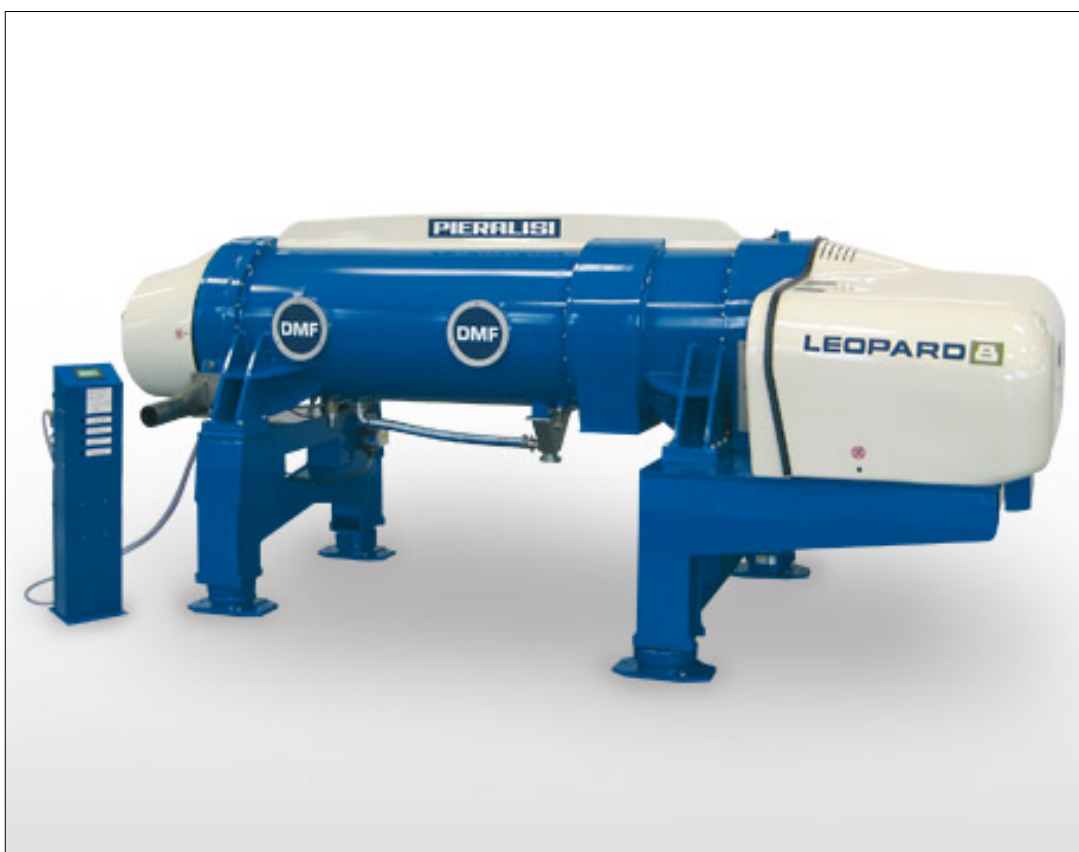
Fig.13 Estrattore centrifugo a due fasi DMF Pieralisi che recupera la polpa della sansa, definita “paté”, ideale per l’utilizzo agronomico e l’alimentazione zootecnica.
